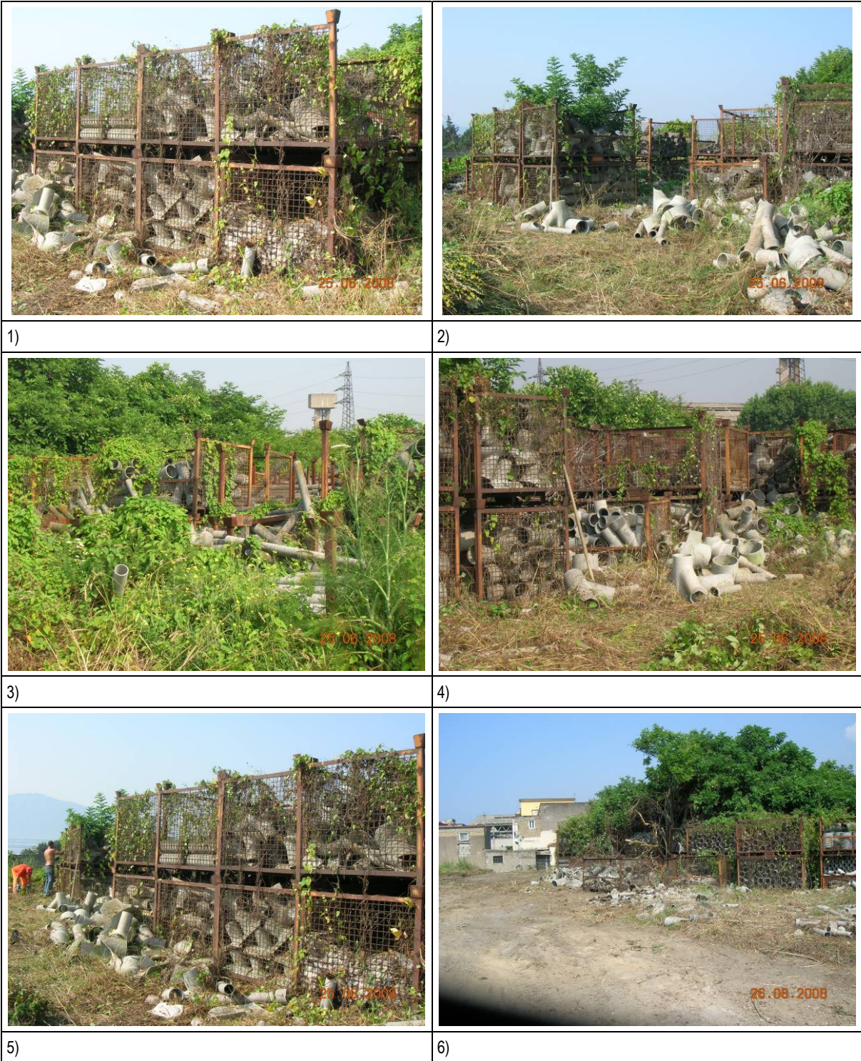
Figura 4.2.1 – Lavorati in fibrocemento abbandonati alle intemperie
