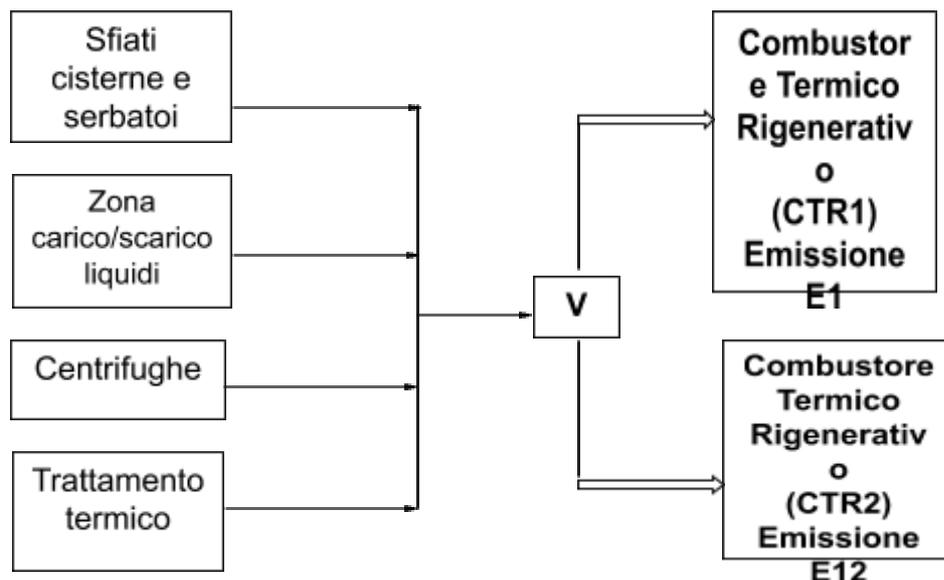
Con l'obiettivo di ottimizzare il costo energetico complessivo dello stabilimento, è consentita la messa in opera di un by-pass tra i due Combustori (CTR1 e CTR2) in modo tale che, a seconda delle operazioni gestionali in corso, possano asservire entrambi o solo uno dei due sistemi operativi in esercizio, sempre nel rispetto dei valori limiti degli inquinanti di cui alla successiva Tab. 2.
