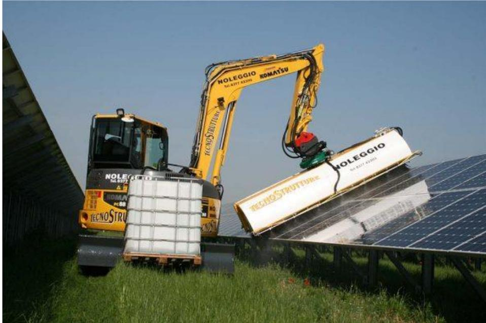
*Sistema automatizzato lavaggio moduli fotovoltaici*
