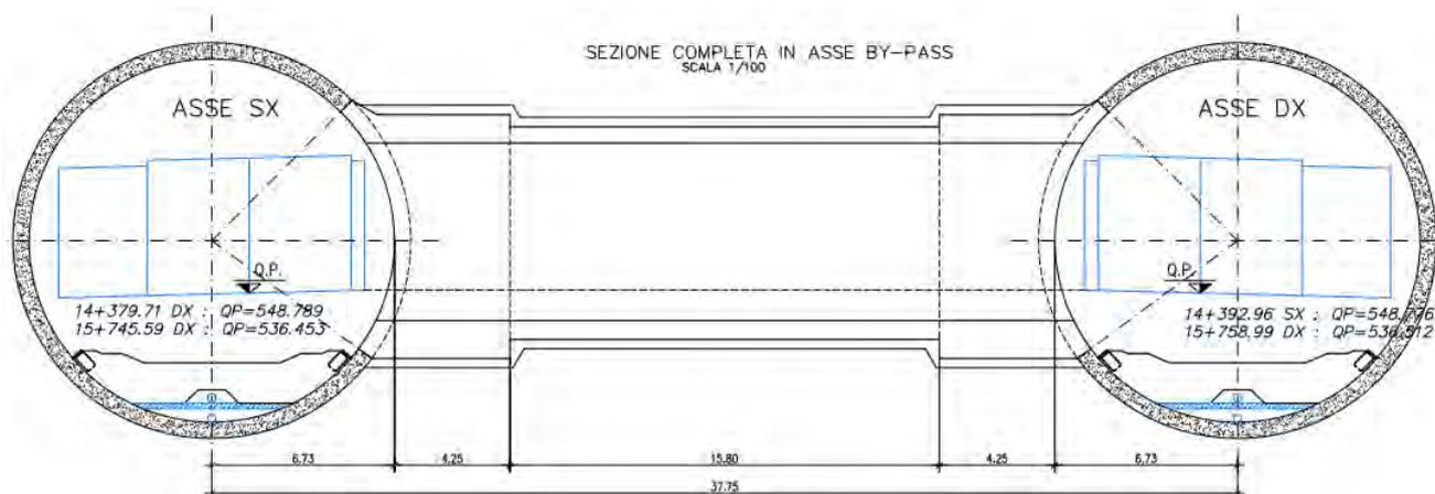
Figura 7.13: sezione tipo bypass carrabile – sezione longitudinale – carpenteria rivestimento definitivo
