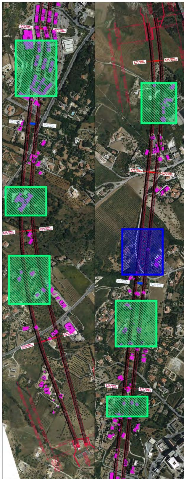
Figura 7.1: planimetria con ubicazione bypass di PVT – zone critiche
