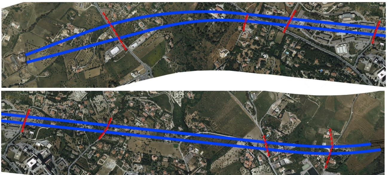
stralcio planimetrico con ubicazione degli stendimenti di subsidenza (rosso)
