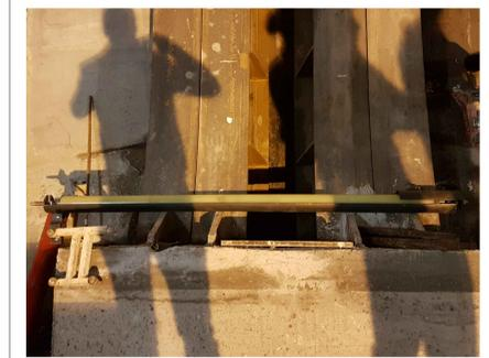
Foto 2 - Puleggia a rullo da inserire nei carotaggi Ø 80/100 per regolazione impronta di taglio.
