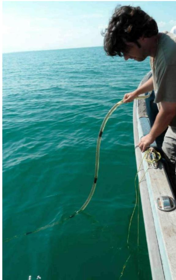
**Figura 6 - Streamer monocanale GeoResources.**
