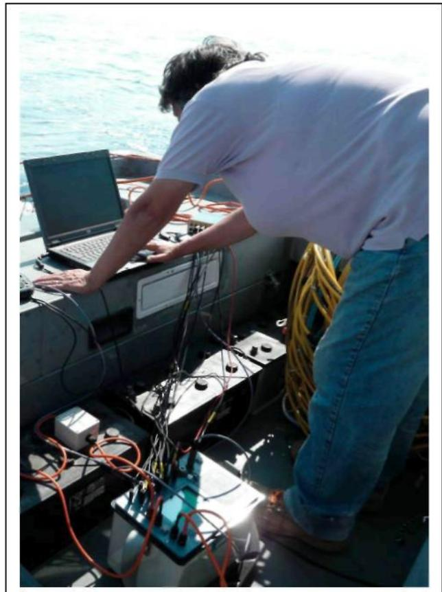
**Figure 10 e 11 - il georesistivimetro IRIS Syscal DEEP Marine (in alto) ed il controllo dei dati di resistività acquisiti sul display del PC notebook dedicato da parte di un tecnico a poppa della imbarcazione**
