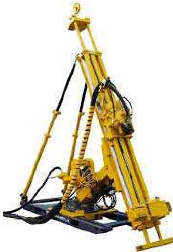
Immagini 16 – 17: tipologia di sonda per carotaggio da sotterraneo
