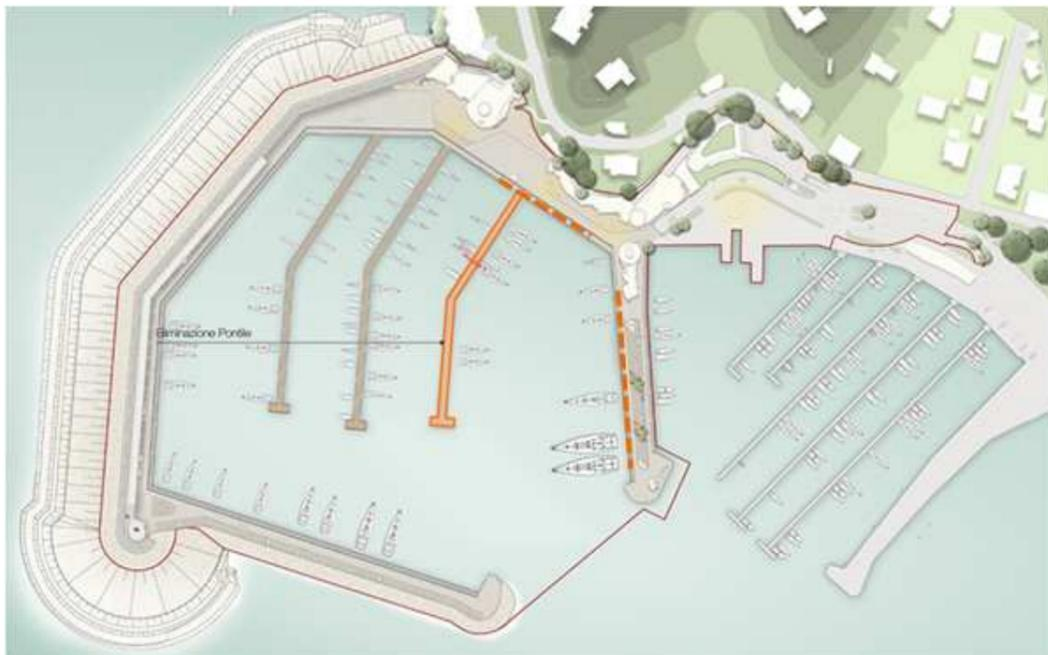
**Figura 4.1 – Planimetria di progetto con rappresentazione del pontile da eliminare e dei tratti di banchina da rinforzare**
