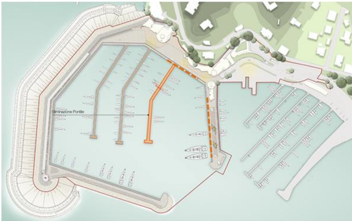
Figura 5.1 – Planimetria di progetto con rappresentazione del pontile da eliminare e dei tratti di banchina da rinforzare
