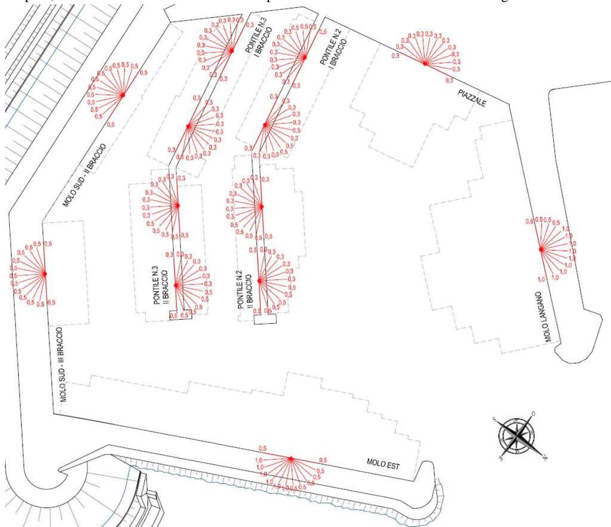
Figura 8: Schema planimetrico con indicazione dei fattori di schermo - verifiche degli ormeggi a terra
