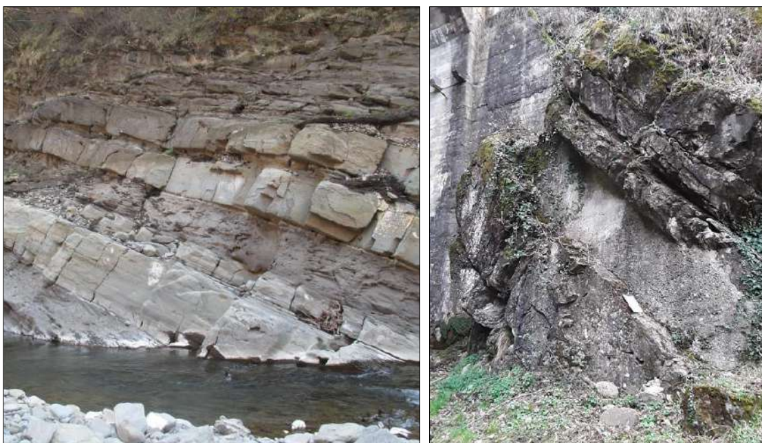
Figura 4-37: Aspetto del membro arenaceo-pelitico CDP2 in destra idrografica dell'invaso (sinistra) e a valle della diga (destra)
