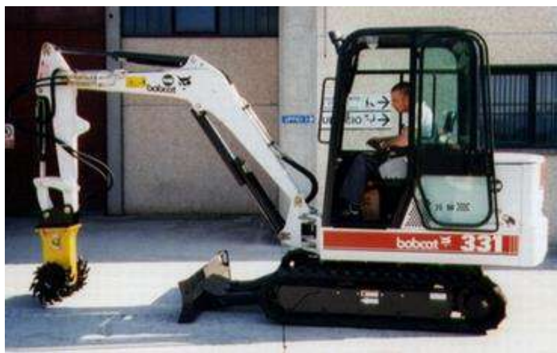
Figura 3-37: Esempio di Escavatore di piccole dimensioni dotato di testa fresante
