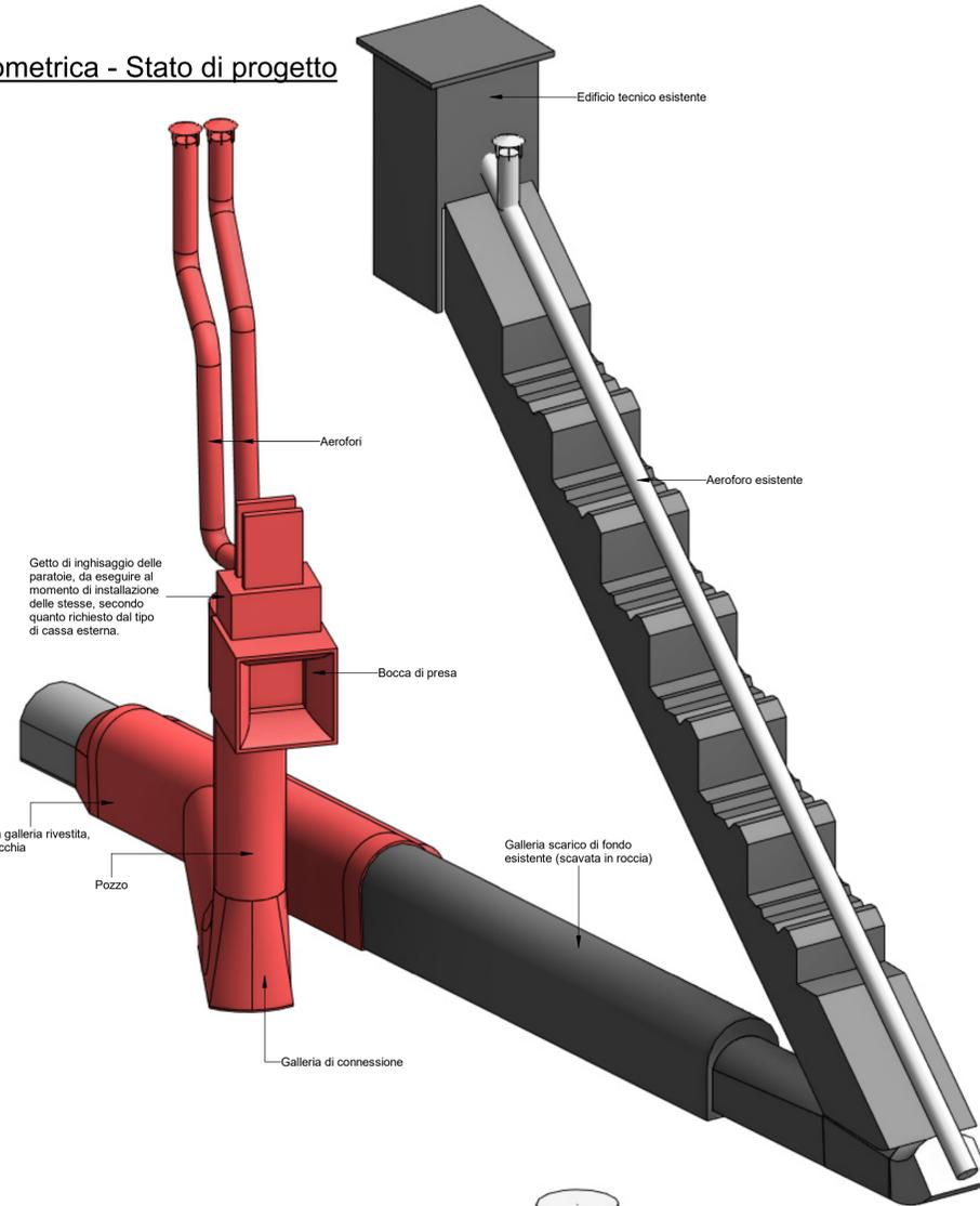
Vista assonometrica - Galleria di connessione e raccordo
