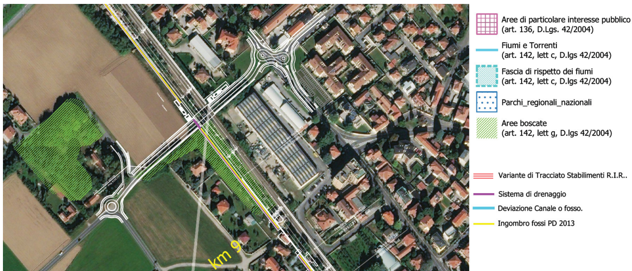
Figura 14 – Interferenza fosso drenante con una fascia boscata in corrispondenza del nuovo sottovia “Via Resegone” (Comune di Parabiago) – interferenza già presente nel PD 2013
