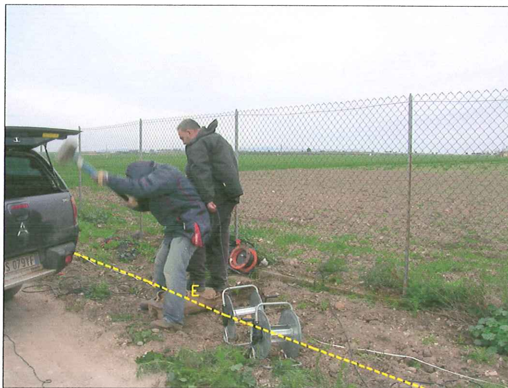
Foto 8: Postazione ed allineamento della Base Sismica B.S.2 - particolare dell'esecuzione di una battuta in onde S nel punto di scoppio E -
