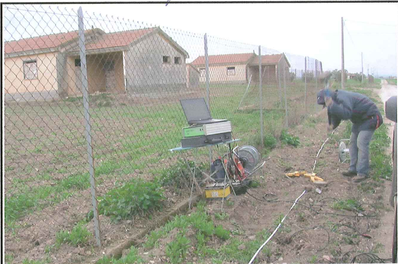
[particolare dell'esecuzione di una battuta in onde P nel punto di scoppio E della Base Sismica B.S.2]
