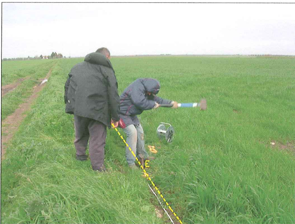
Foto 4: Postazione ed allineamento della Base Sismica B.S.1 - particolare dell'esecuzione di una battuta in onde S nel punto di scoppio E -
