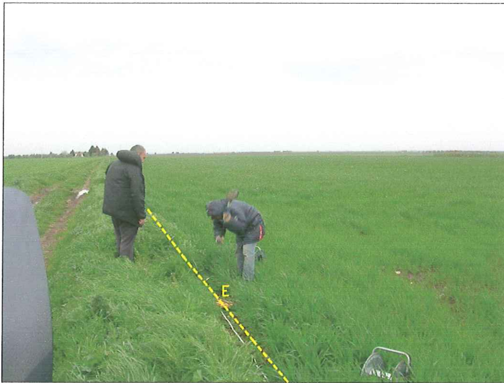
Foto 3: Postazione ed allineamento della Base Sismica B.S.1 - particolare dell'esecuzione di una battuta in onde P nel punto di scoppio E -
