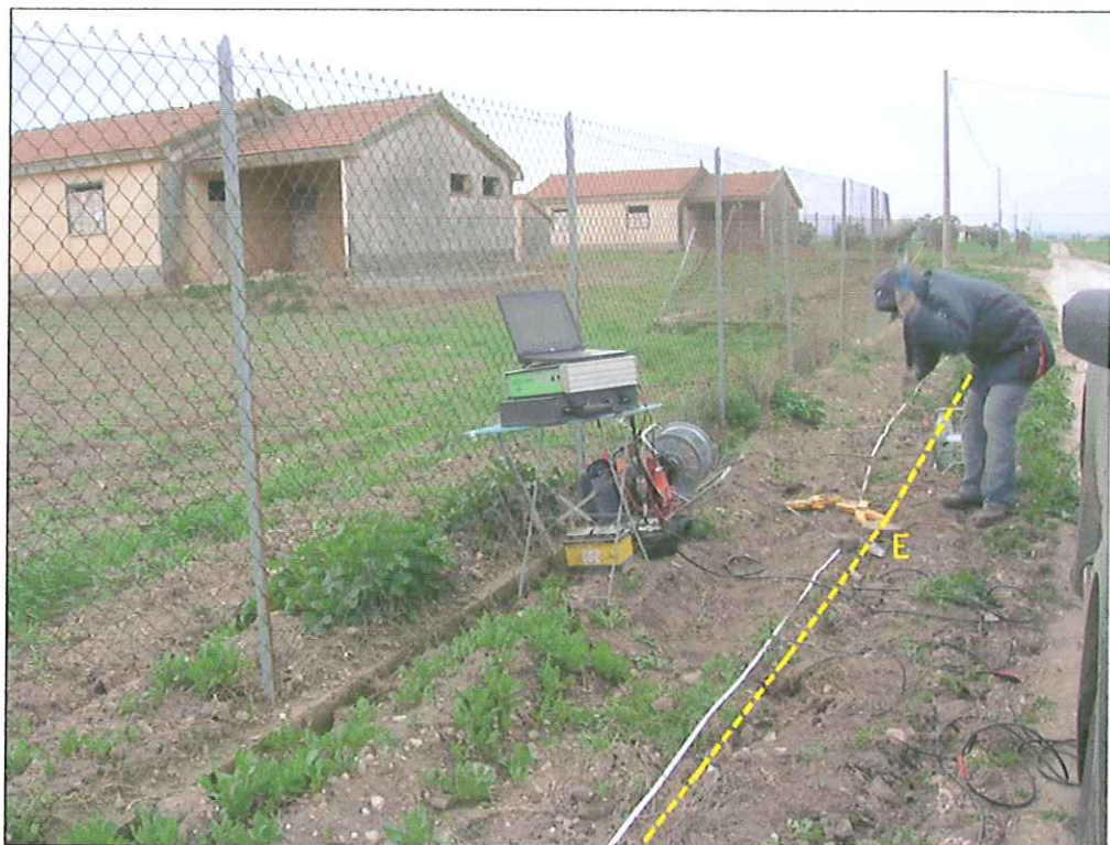
Foto 7: Postazione ed allineamento della Base Sismica B.S.2 - particolare dell'esecuzione di una battuta in onde P nel punto di scoppio E -
