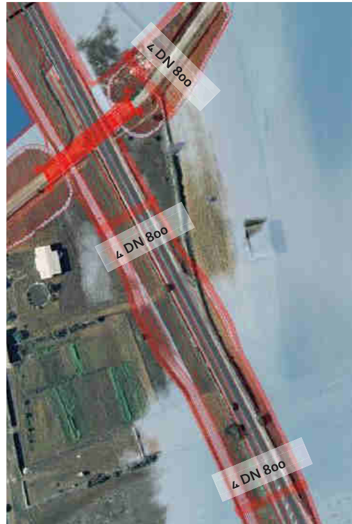
Figura 36: Batterie di tombini di progetto per garantire la trasparenza idraulica.
