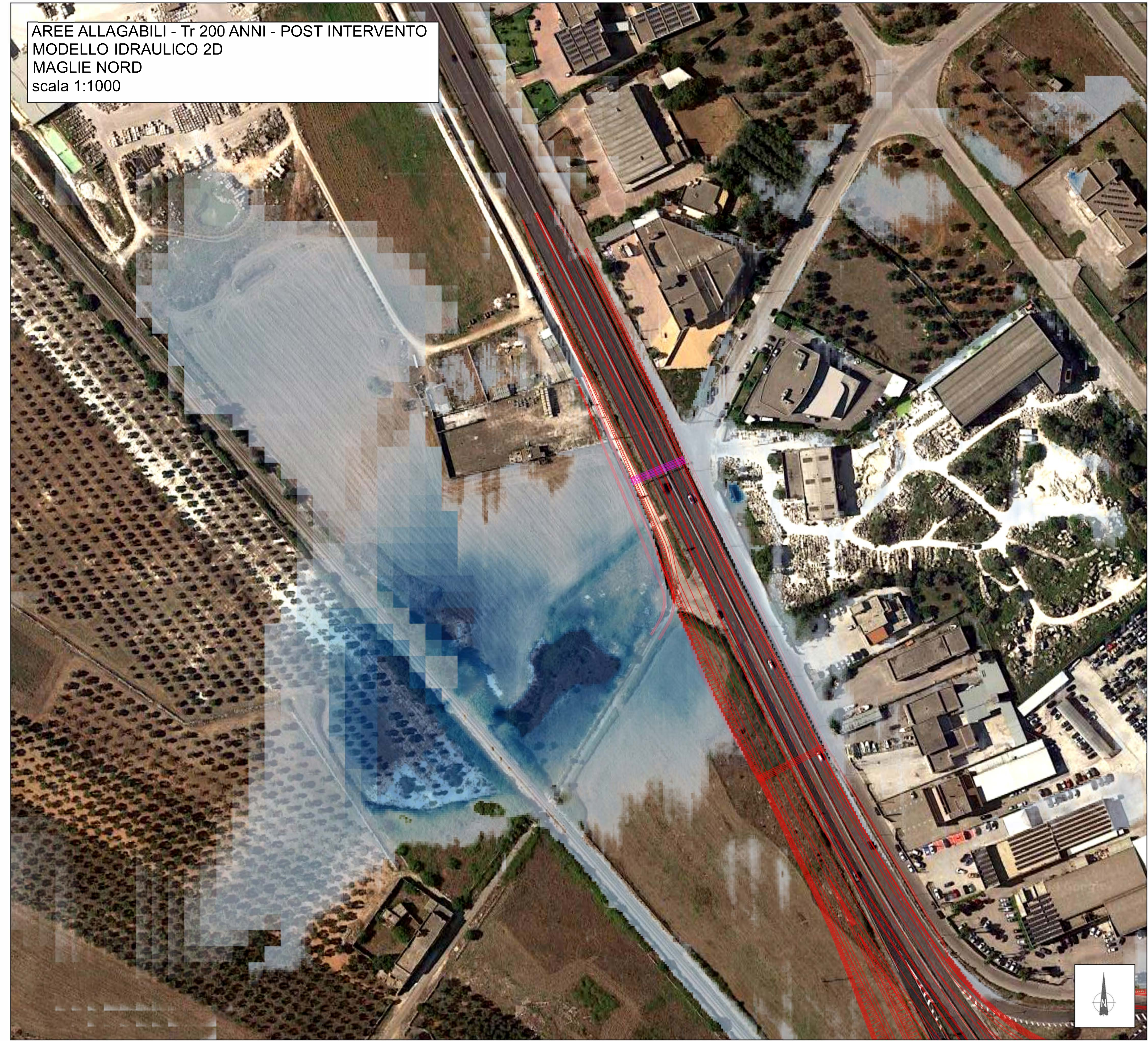
PLANIMETRIA COLLETTORE IDRAULICO - POST INTERVENTO AREE ALLAGABILI Tr 200 ANNI - MODELLO IDRAULICO 2D scala 1:500
