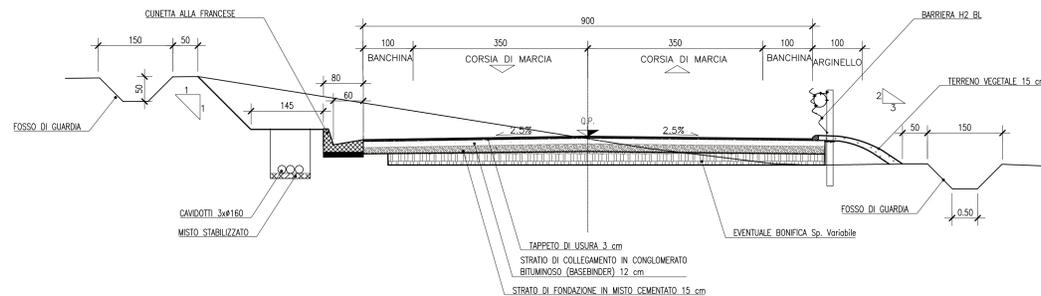
SEZIONE TIPO IN MEZZA COSTA (TIPO F2)
