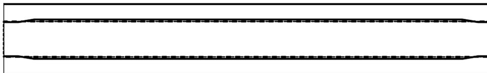
La precompressione della trave avviene per mezzo di 56 Trefoli stabilizzati del diametro di 6/10S", suddivisi in 4 gruppi disposti a diverse altezze della sezione.
