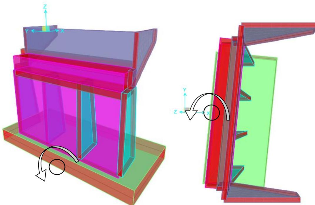
Figura 12-6 – Zattera di fondazione: cinematico di ribaltamento
