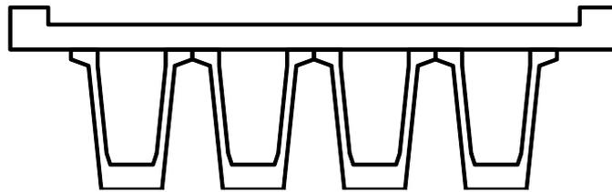
La trave è del tipo a cassone precompressa a fili aderenti e presenta due tipi di sezione: una sezione corrente di tipo A e una sezione ringrossata tipo B in corrispondenza degli appoggi per una lunghezza di 1m. La zona di raccordo tra le due sezioni misura una lunghezza di 1m.
