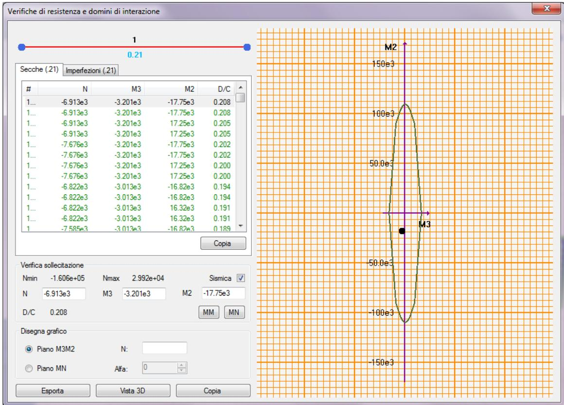
Figura 11-3 – Pila 2: Dettaglio verifica PMM – piano MM (unità di misura: kN; m; °C)
