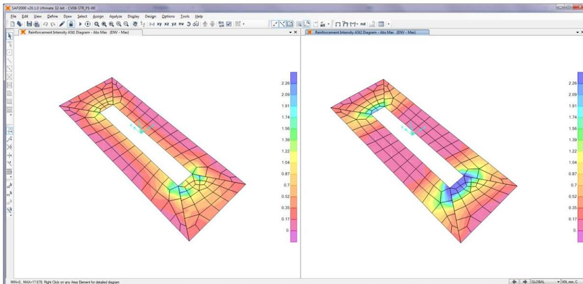
Figura 10-11 – Richiesta di armatura: Ast1\_SX e Ast2\_DX
