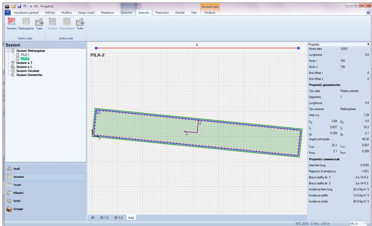
Figura 11-1 – Pila 2: sezione di verifica 7.285 x 1.00 –  $\phi 26/10$
