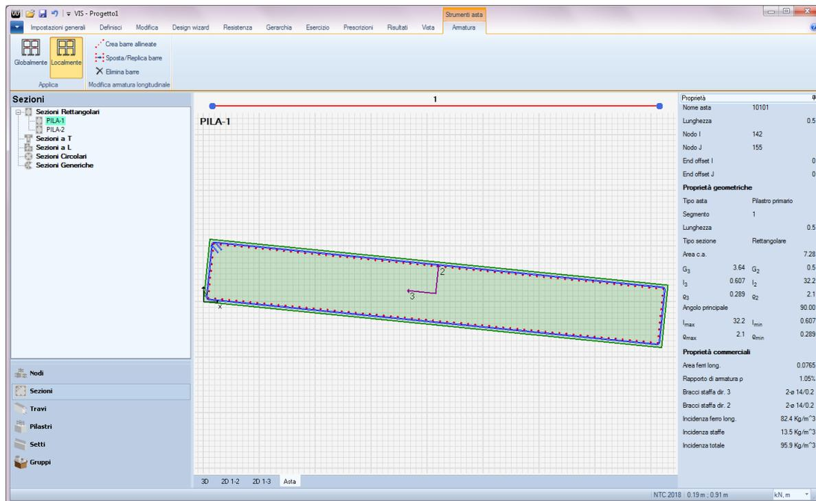
Figura 10-1 – Pila 1: sezione di verifica 7.285 x 1.00 –  $\phi$ 26/10
