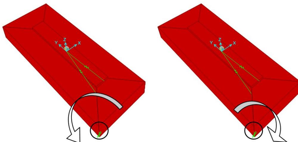
Figura 10-12 – Zattera di fondazione: cinematico di ribaltamento
