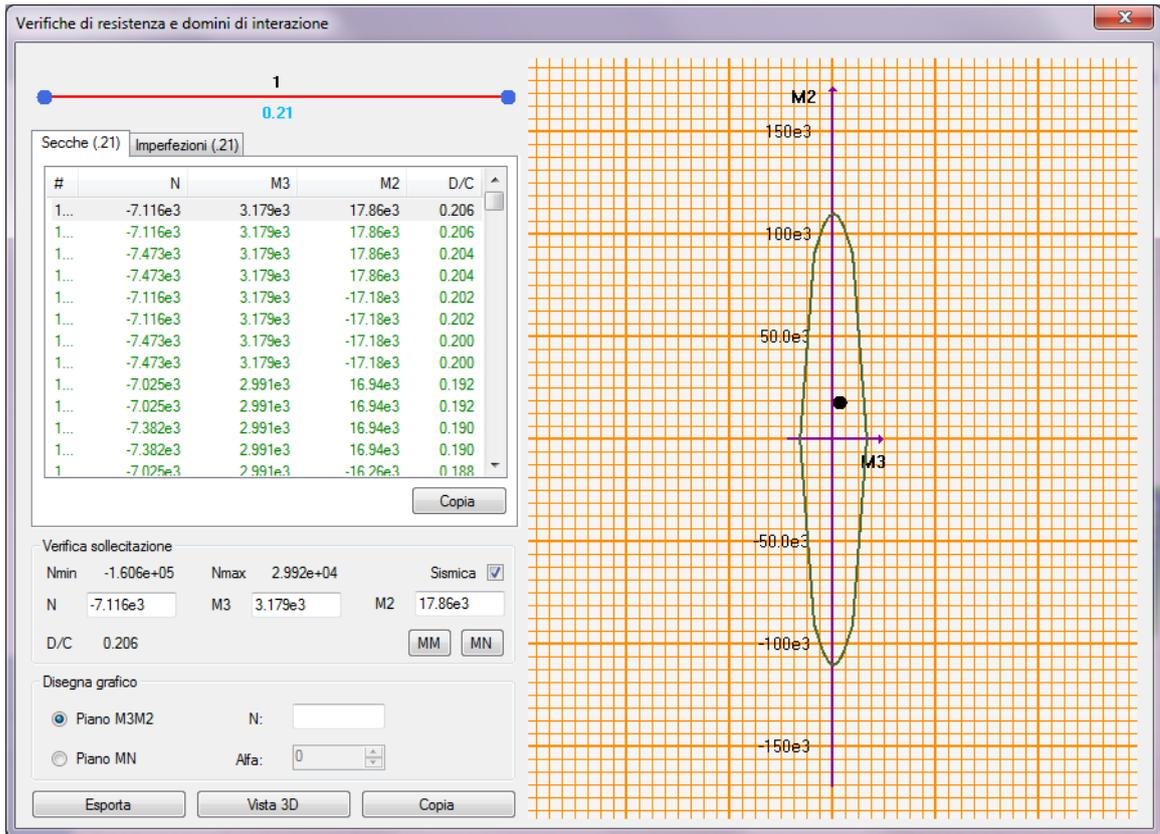
Figura 10-3 – Pila 1: Dettaglio verifica PMM – piano MM (unità di misura: kN; m; °C)
