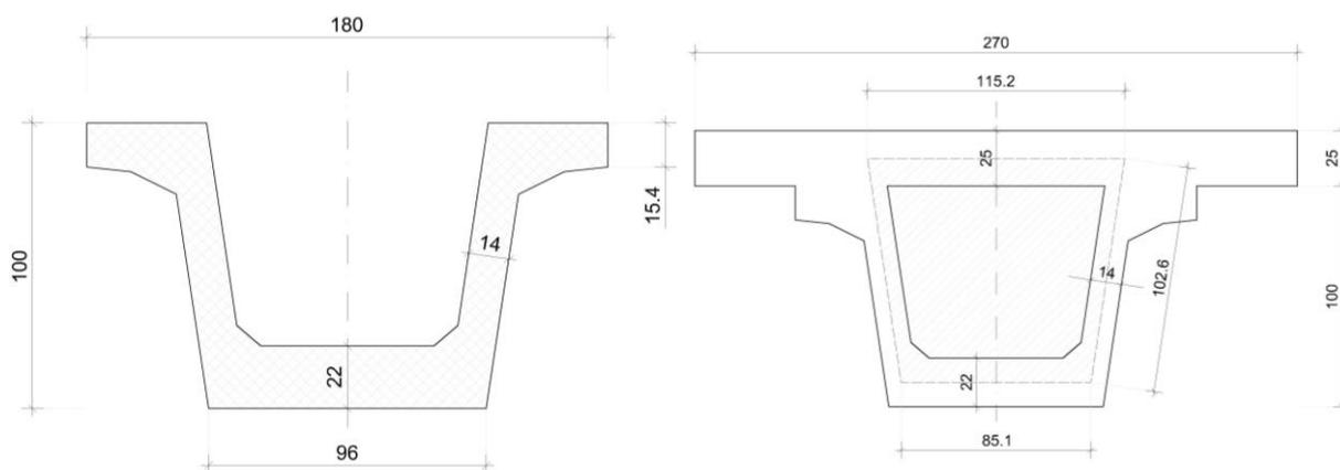
**F 7. Geometria sezione corrente trave e sezione corrente trave+soletta –  $i=2.87 \rightarrow 2.39m$**
