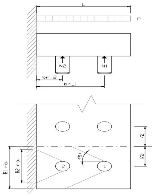
La verifica strutturale del palo viene condotta ipotizzando la sua sommità impedita di ruotare. Il palo viene immerso nel terreno ipotizzato come semispazio elastico che offre, in funzione dei parametri di resistenza laterale tratti dall'analisi geotecnica della stratigrafia ( $E_{soil}$ ), una resistenza elastica modellata con molle alla Winkler la cui rigidezza è ricavata direttamente dal modulo elastico del terreno secondo la relazione:
