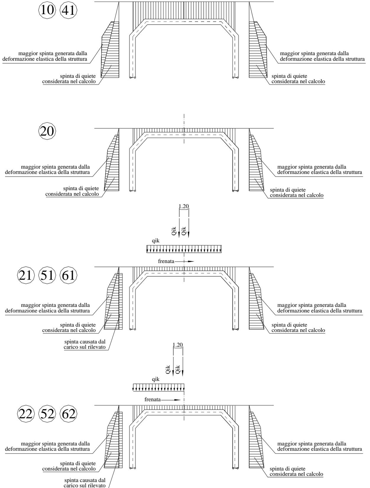
Sottopasso su SV1 – OM01 - Relazione di calcolo strutturale: Archi
