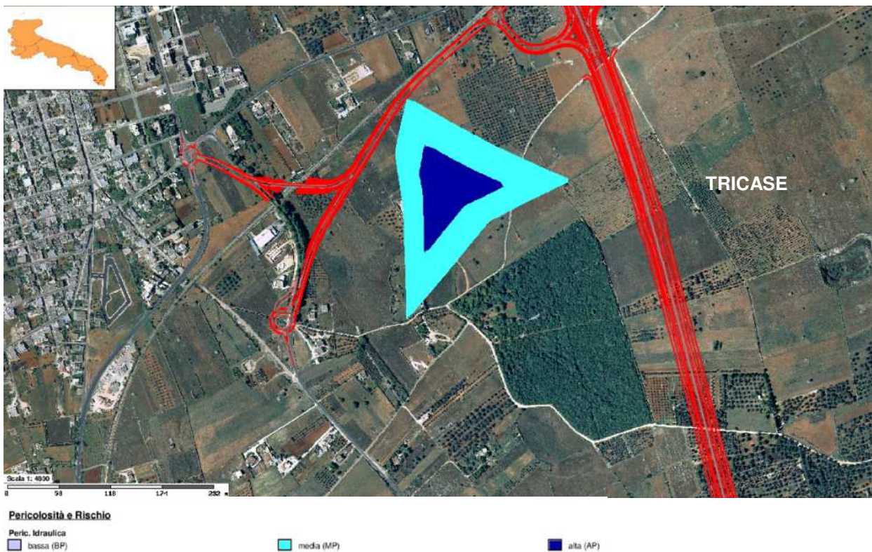
Figura 6-38. Stralcio PAI con sovrapposizione intervento di progetto nel Comune di Tricase: Pericolosità Idraulica
