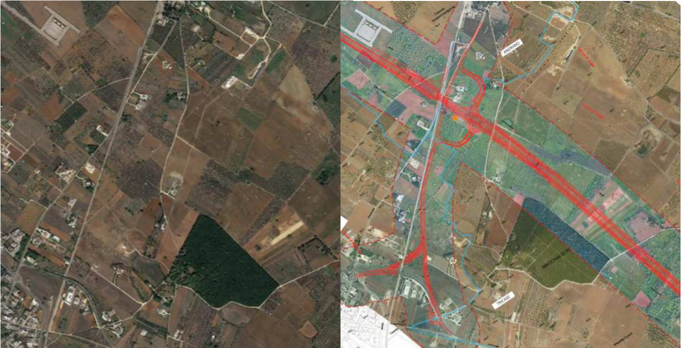
Figura 4-7. Ortofoto stato attuale e con sovrapposizione del tracciato dell'infrastruttura di progetto con relativa fascia di rispetto stradale nei pressi della ZSC Bosco Macchia di Ponente.
