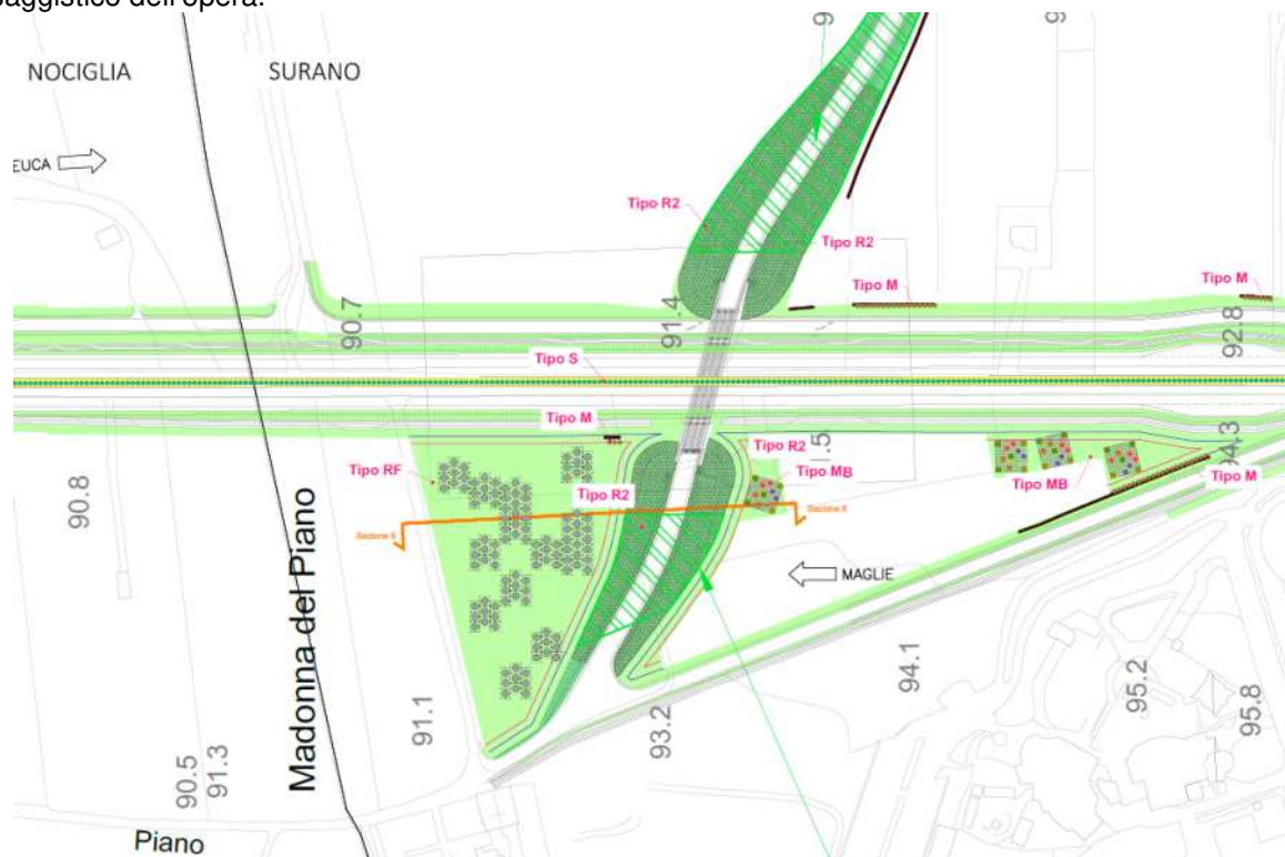
Figura 9-35. Planimetria della sistemazione delle opere a verde dello Scavalco CV20 Comune di Surano in corrispondenza della complanare per la Chiesa della Madonna di Leuca (Madonna del Piano) - sistemazione delle opere a verde con evidenza verde di inerimento
