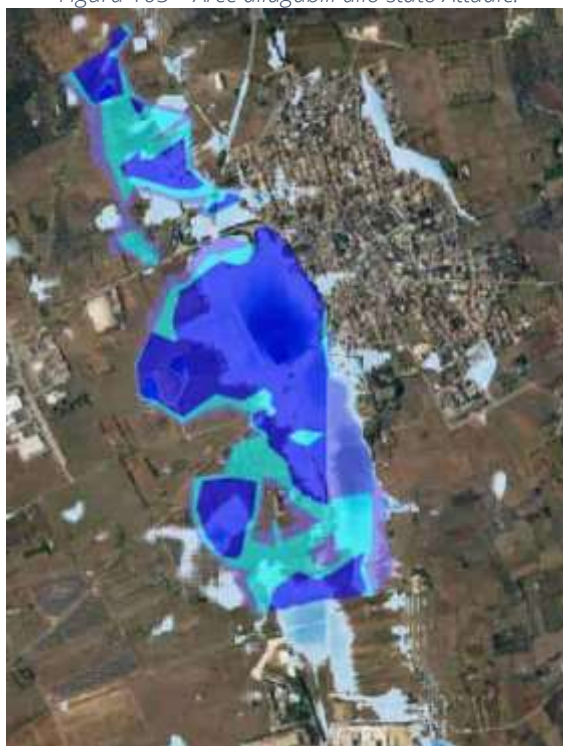
Figura 106 - Confronto area PAI vigente con modello idraulico bidimensionale.
