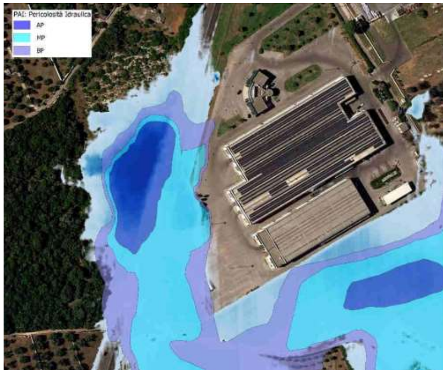
Figura 103 – Confronto area PAI vigente con modello idraulico bidimensionale.
