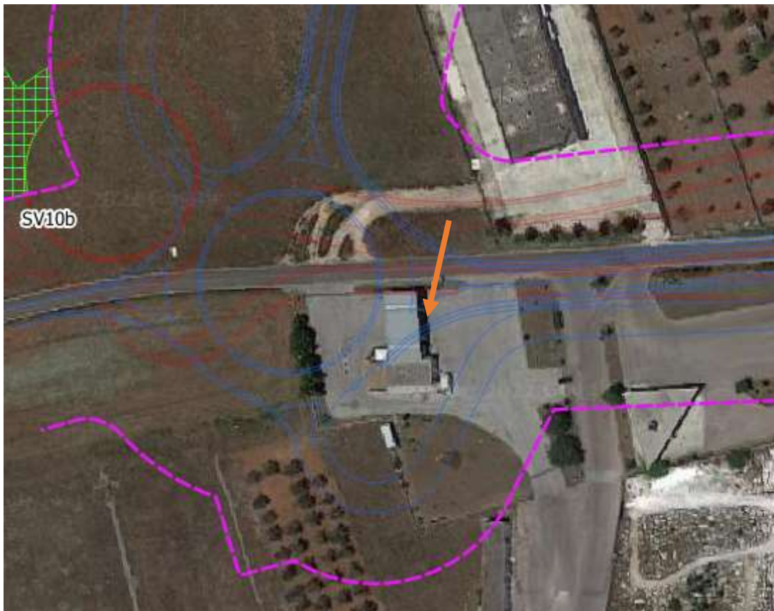
Figura 47 – Foto aerea di dettaglio con evidenza dell’interferenza tra progetto approvato in blu e distributore di servizio indicato con la freccia arancione.
