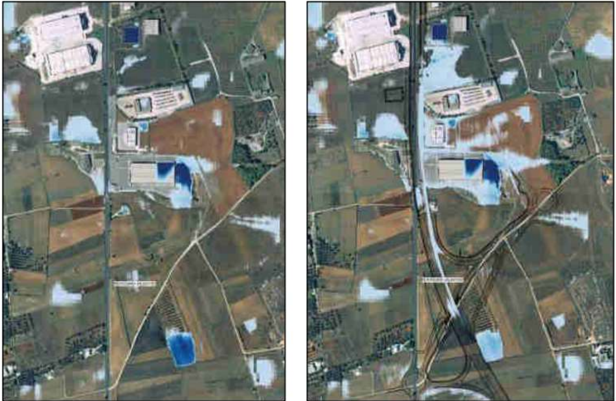
Figura 134 – Confronto Simulazione Stato attuale e Stato di progetto TR 200 anni - Tratto pk 18+150.
