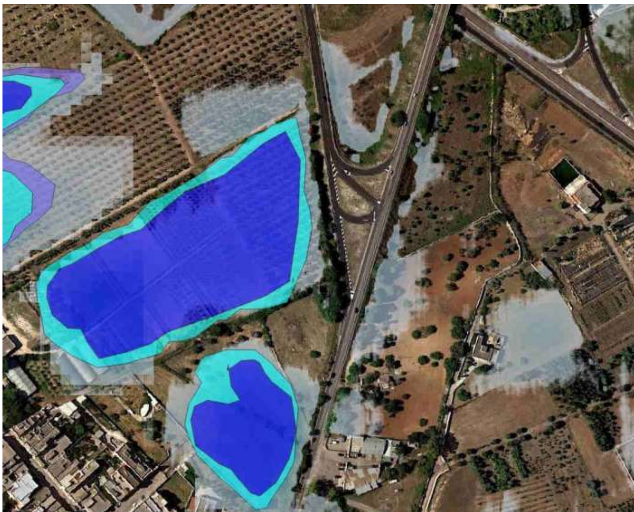
Figura 100 – Confronto area PAI vigente con modello idraulico bidimensionale.
