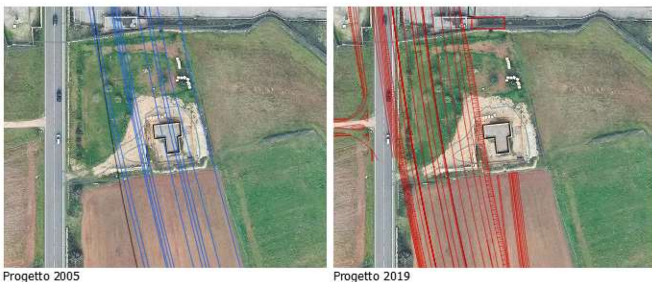
Figura 50 – A sinistra l'interferenza tra l'asse principale del progetto approvato e l'edificio. A destra progetto revisionato con risoluzione dell'interferenza.
