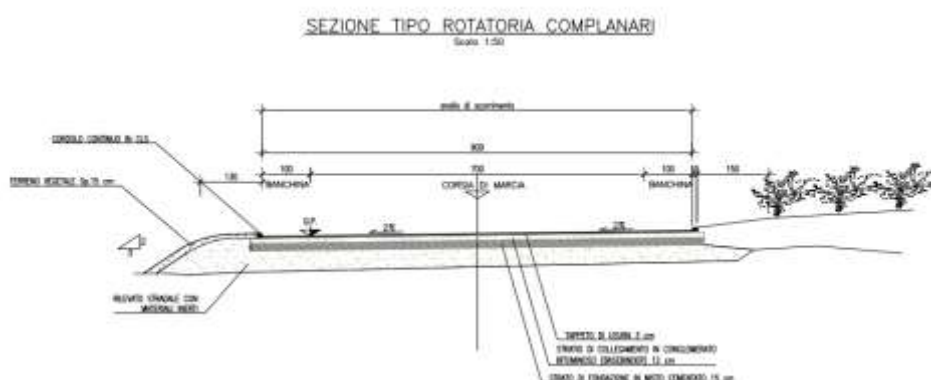
Figura 7 – Sezione tipo relativa a rotatoria svincoli
