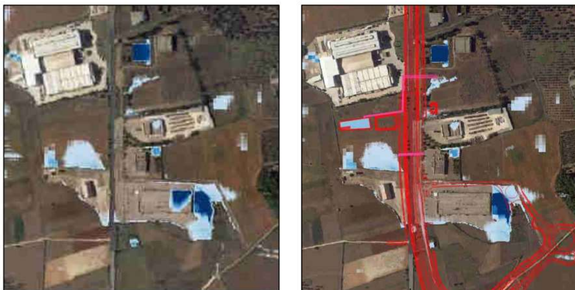
Figura 135 – Confronto Simulazione Stato attuale e Stato di progetto TR 200 anni - Tratto pk 18+150 con inserimento dell'opera di mitigazione.
