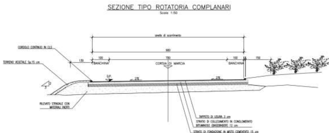
Figura 31 - Sezione tipo complanare L=9,0 m in rilevato
