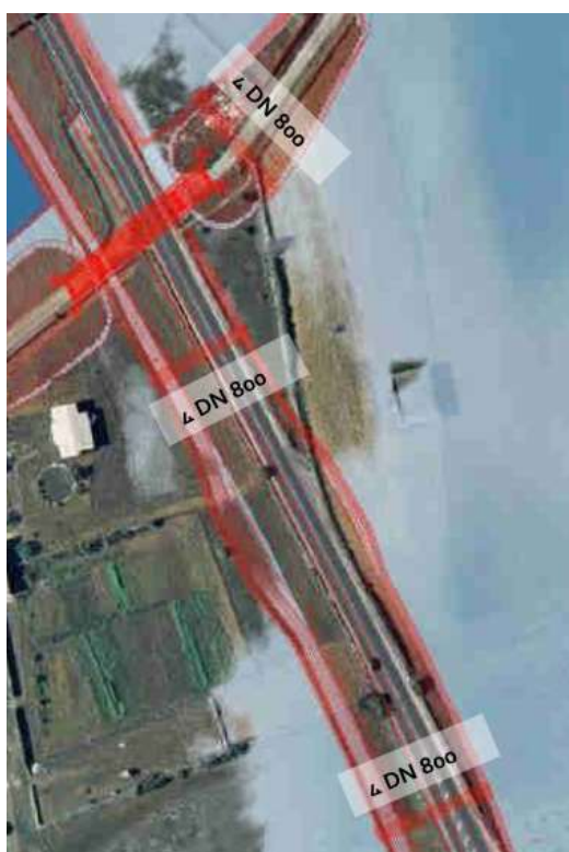
Figura 130 - Batterie di tombini di progetto per garantire la trasparenza idraulica.
