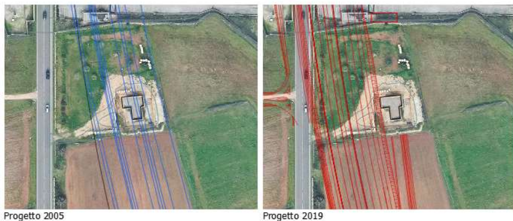
Figura 29 – A sinistra l'interferenza tra l'asse principale del progetto approvato (in blu) e l'edificio. A destra progetto revisionato con risoluzione dell'interferenza.
