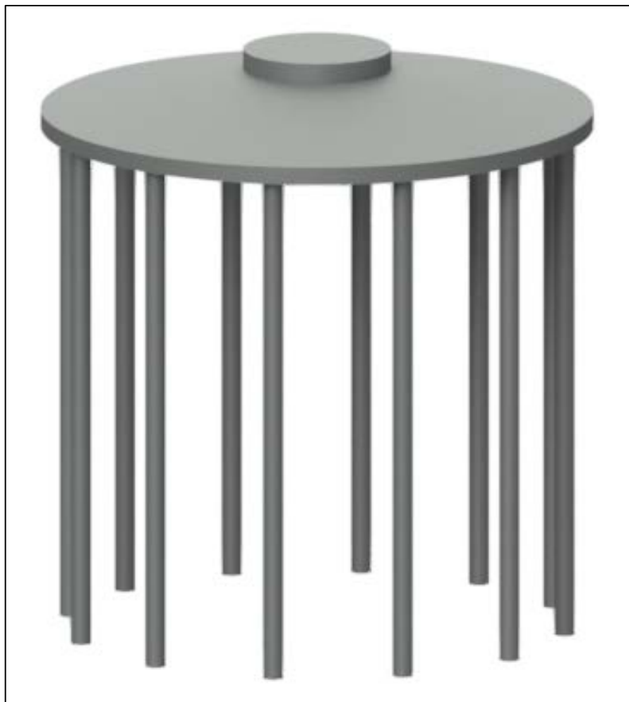
Figura 9: vista tridimensionale della fondazione dell'aerogeneratore
