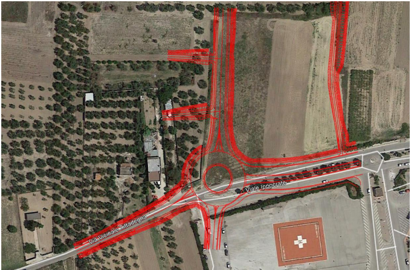
Figura 13 - Stralcio dell'interferenza tra l'ingombro della stazione e la viabilità Via Vicinale Tittadegna, Viale Ippocrate (Fonte: Google Earth)
