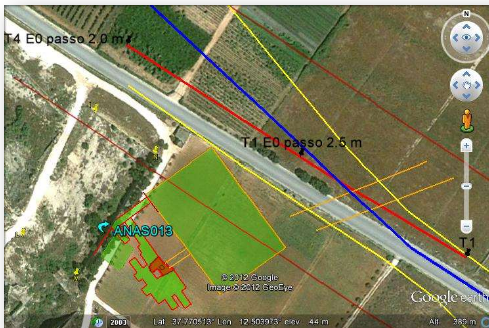
Fig. 6.6 – Area di indagine in cui sono stati riconosciute due direzioni preferenziali di scavo: N54E e N114E. L'area in verde
