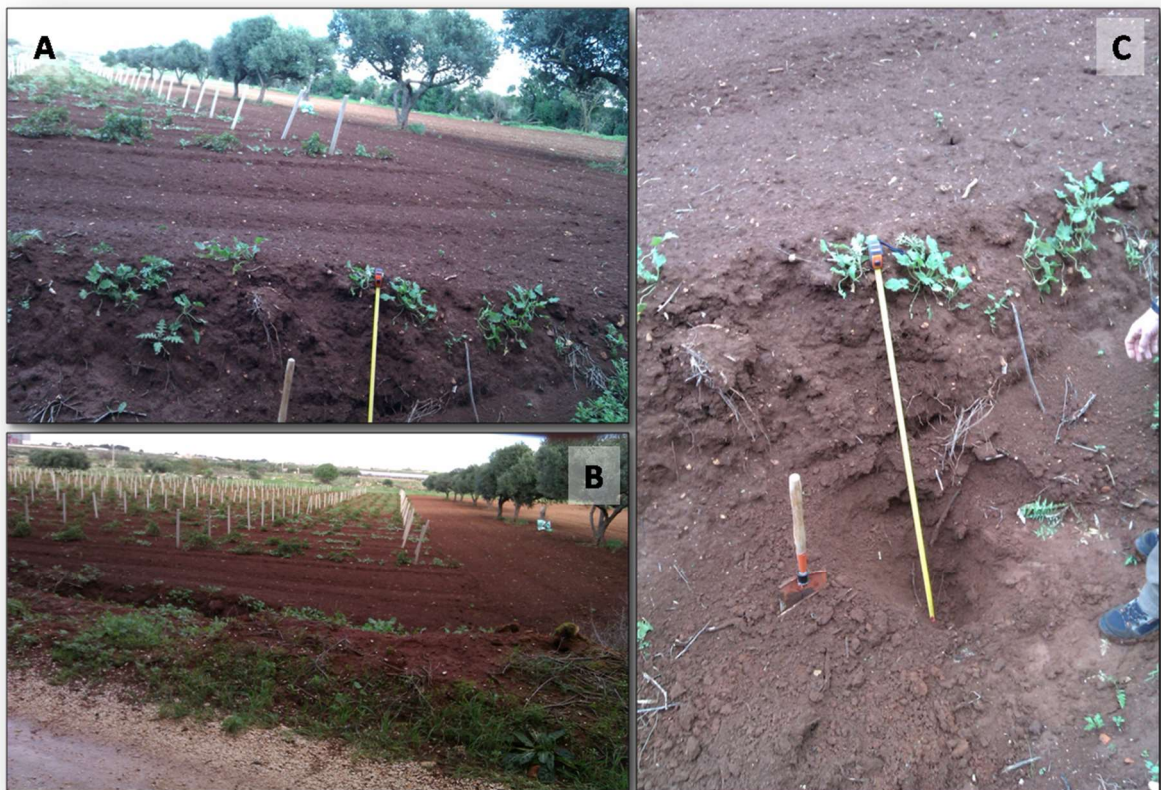
Fig. 8.4 – Rilievo in corrispondenza di campi coltivati. In questo punto il substrato è stato intercettato ad una profondità di 1,3 m dal p.c. Archivio 2012
