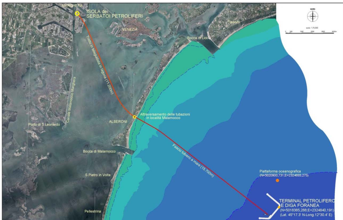
Figura 2.2 - Terminal petrolifero – Percorso delle pipelines
