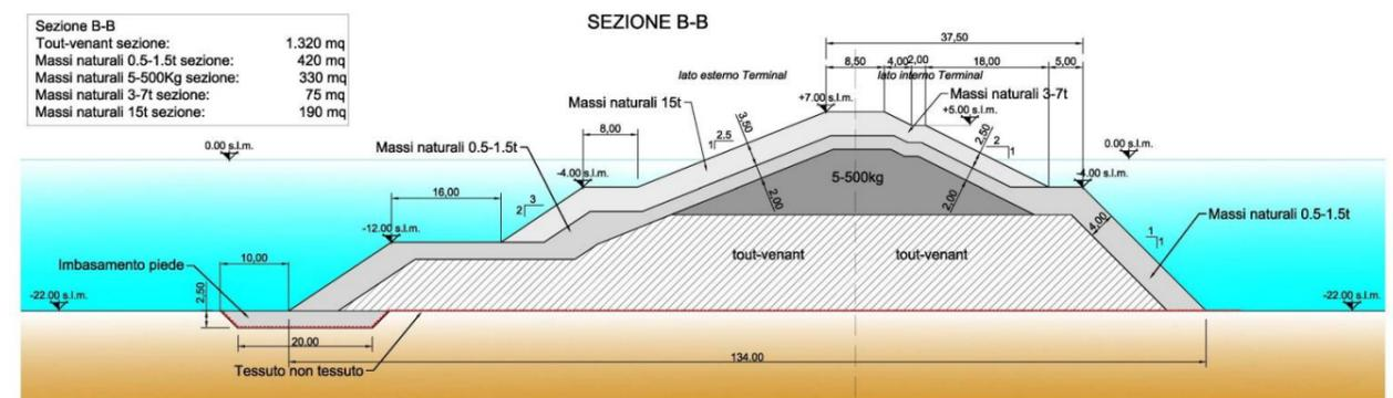
**Figura 7 – Diga foranea – Sezione Tipo B-B**
