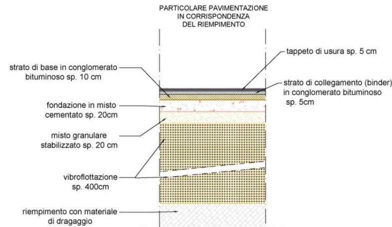
**Figura 13 - Pavimentazione - sezione tipo in corrispondenza del riempimento**
