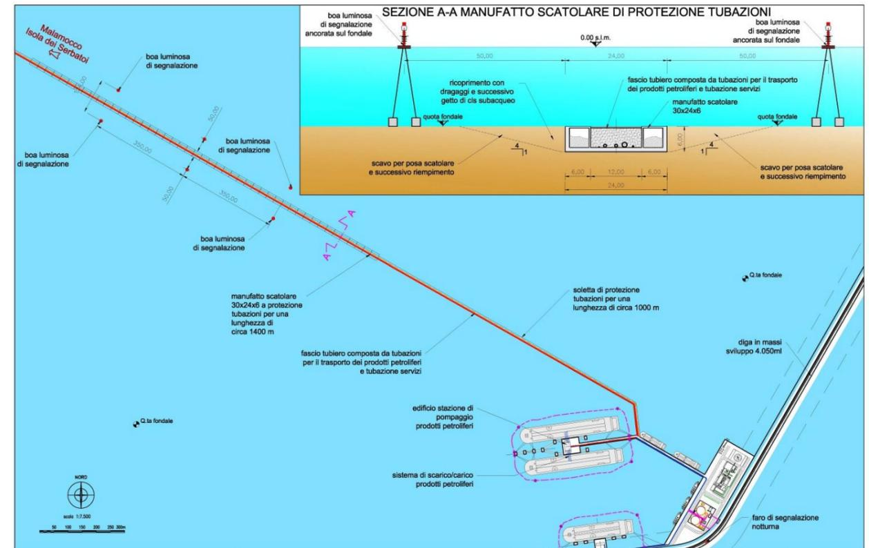
Figura 19 - Fascio tubiero - tratto a mare : sezione di posa in prossimità del terminal petrolifero
