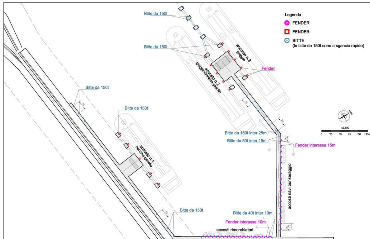
Figura 22 – Terminal petrolifero – dotazioni di banchina
