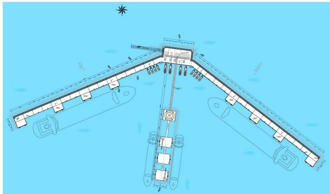
Figura 1 – Progetto Preliminare del Novembre 2002 - Planimetria generale del terminal petrolifero off-shore
