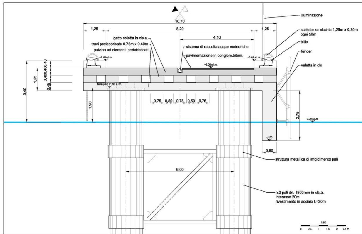
**Figura 10 - Pontile di collegamento con gli accosti n°2 e n°3 - sezione**
