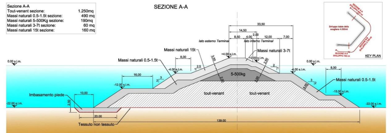
**Figura 6 - Diga foranea – Sezione Tipo A-A**
