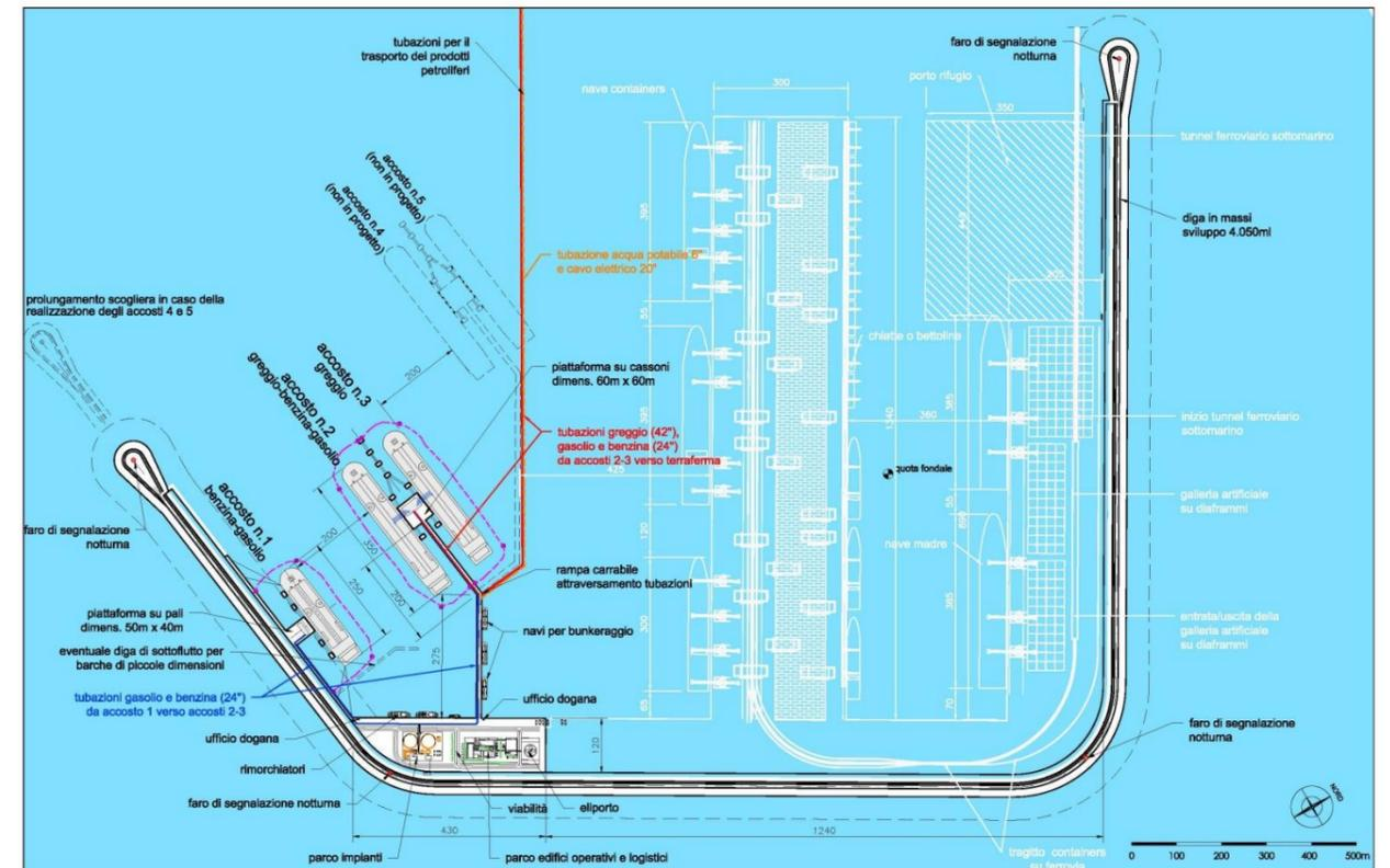
**Figura 4 – Planimetria generale del terminal petrolifero off shore**
