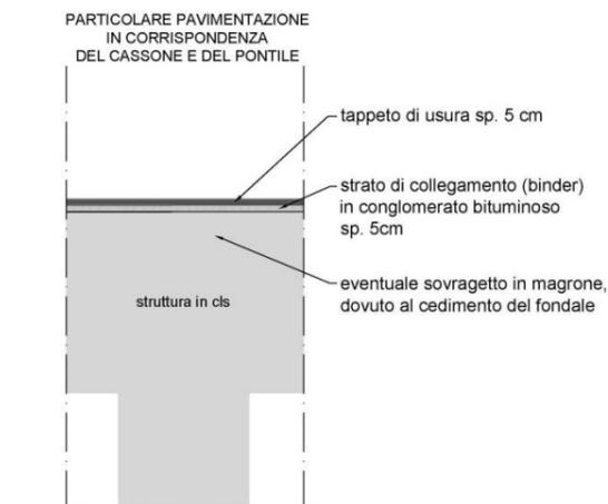
Figura 12 - Pavimentazione - sezione tipo in corrispondenza del cassone
