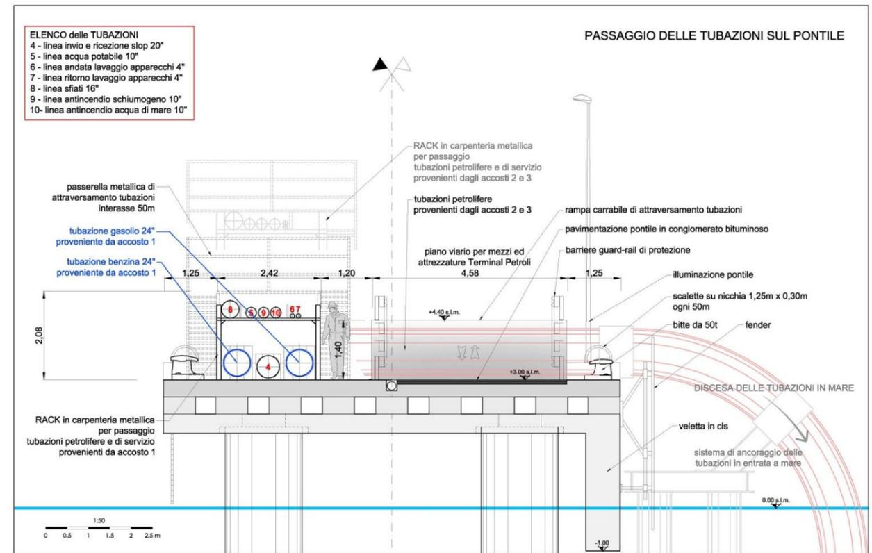
**Figura 11 - Pontile di collegamento con gli accosti 2 e 3 - sezione in corrispondenza delle tubazioni**
