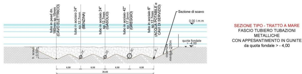
Figura 18 - Fascio tubiero - tratto a mare : sezione di posa da quota fondale > - 4.00 m slmm
