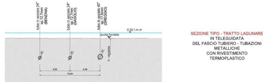
**Figura 20 – Fascio tubiero – tratto lagunare – sezione di posa**
