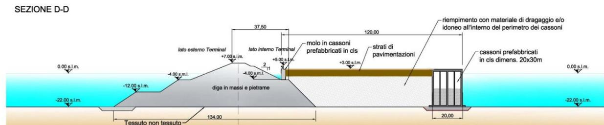
Figura 8 - Diga foranea - Sezione D-D
