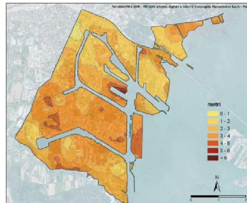
**Figura 26 - Distribuzione dello spessore del riporto all'interno dell'area di Porto Marghera; mappa ricavata dall'interpolazione dei valori puntuali presenti nella banca dati stratigrafica della Provincia di Venezia**
