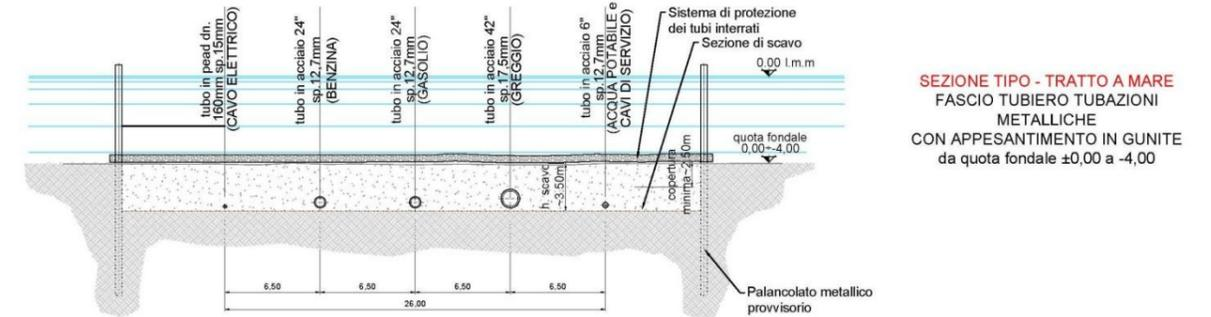
Figura 17 - Fascio tubiero - tratto a mare : sezione di posa fino da quota fondale 0.00 a -4.00 m slmm
