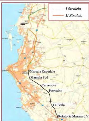
Il progetto costituisce il I Stralcio del più ampio progetto di collegamento tra Mazara del Vallo e Trapani, e prevede la realizzazione di una **infrastruttura stradale di cat. C1**, con una corsia di senso di marcia e larghezza complessiva di 10,5 m.
