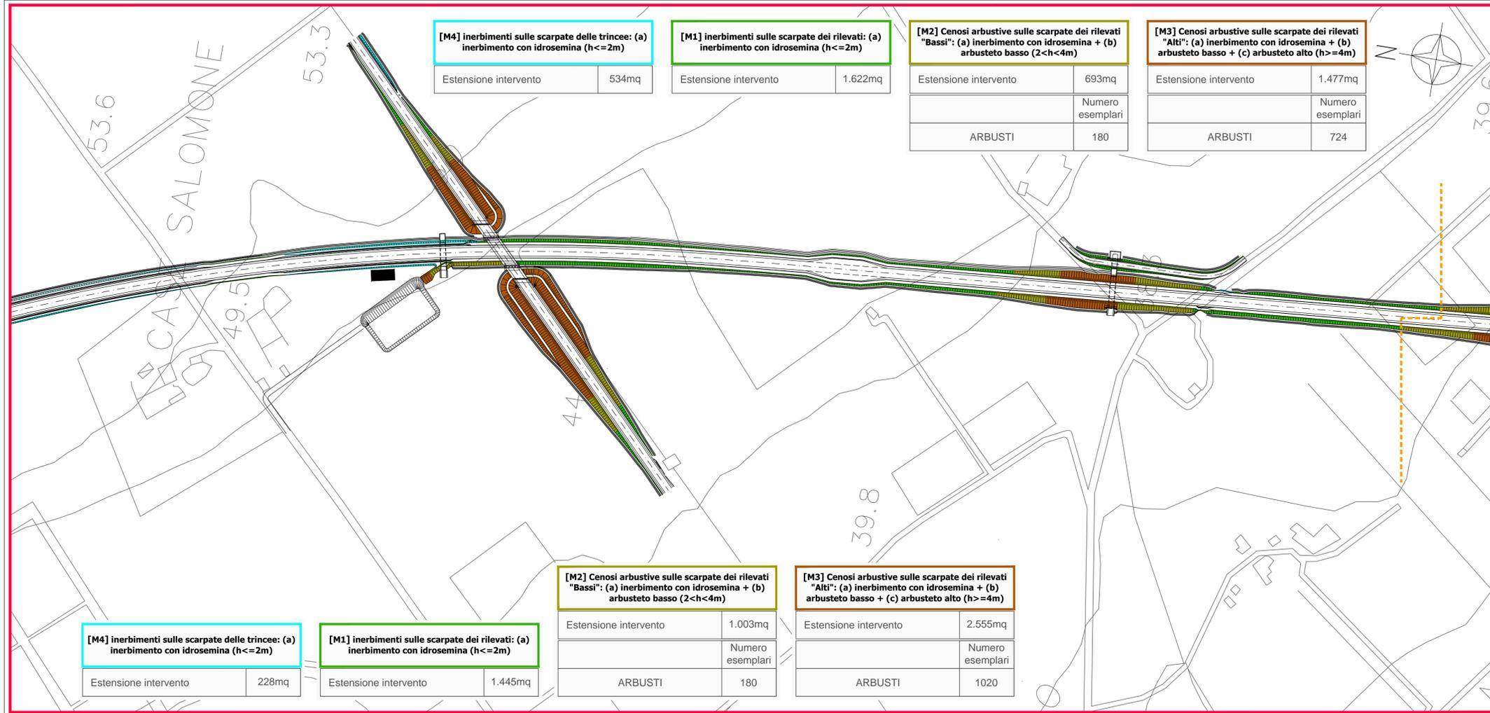
**[M4] Inerbimenti sulle scarpate delle trincee: (a) inerbimento con idrosemina (h<=2m)**
