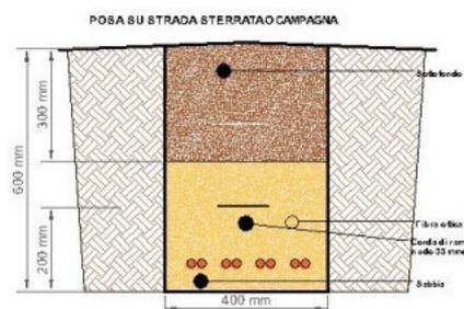
Figura 35: Particolare sezione tipo cavo interrato BT
