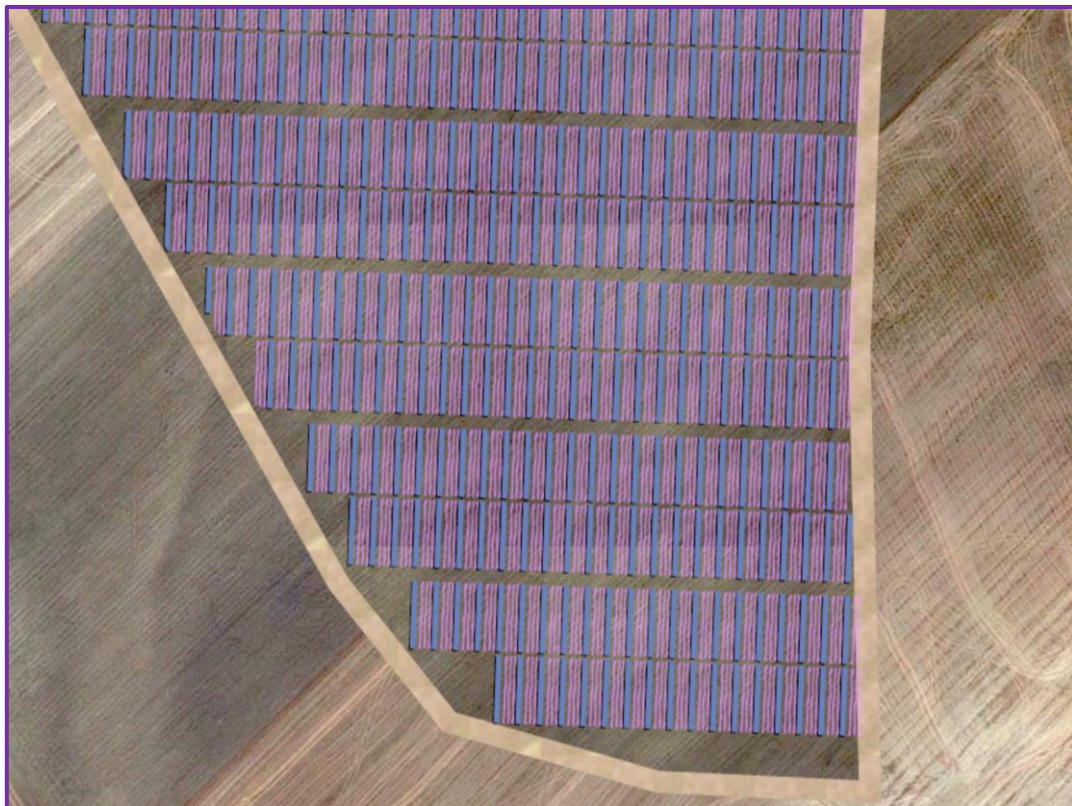
Figura n. 01b: fotoinserimento schematico (del tipo sub-zenitale) della nuova soluzione sviluppata, dove la dilatazione dell'orditura dei tracker e la “penetrazione a pettine” della componente agricola, dà luogo ad una maggiore continuità della tessitura vegetazionale promuovendo, di fatto, un miglior inserimento paesaggistico dell'iniziativa.
