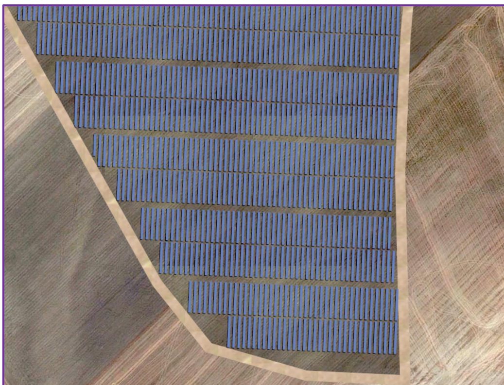
Figura n. 01a: fotoinserimento schematico (del tipo sub-zenitale) della soluzione di un layout tradizionale, dove la concentrazione dei tracker fotovoltaici promuove il cosiddetto "buco di silicio", introducendo di fatto una evidente discontinuità paesaggistica.
