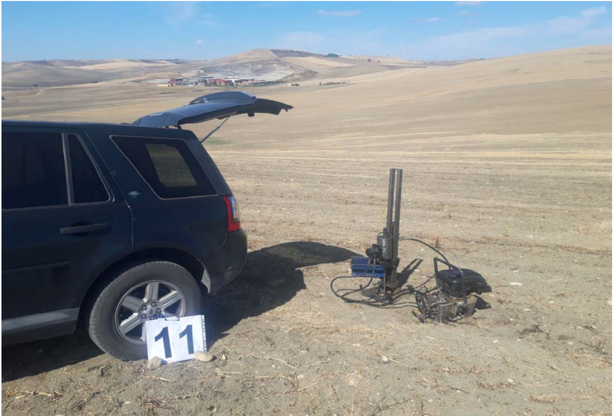
Postazione Prova Penetrometrica Dinamica P11
