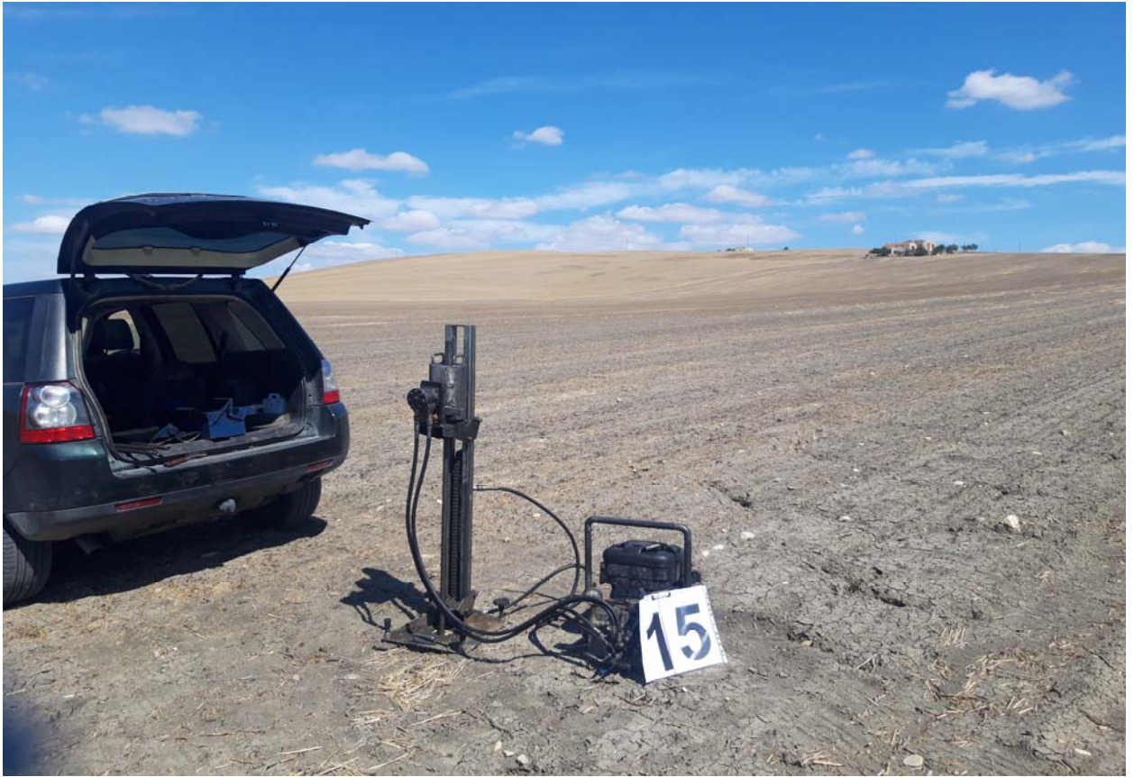
Postazione Prova Penetrometrica Dinamica P15
