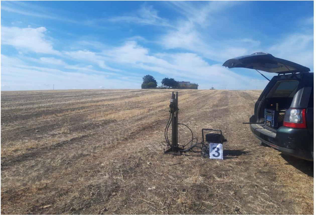
Postazione Prova Penetrometrica Dinamica P3
