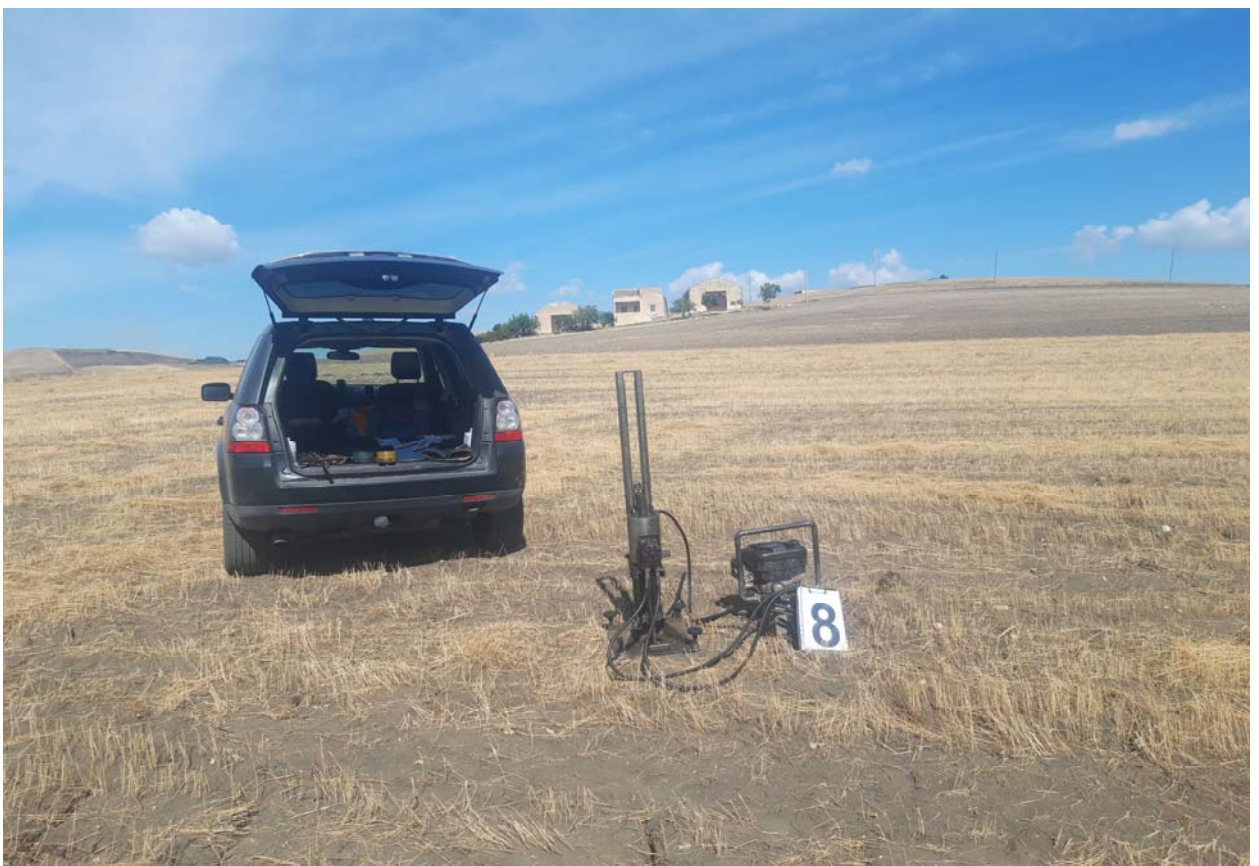
Postazione Prova Penetrometrica Dinamica P8
