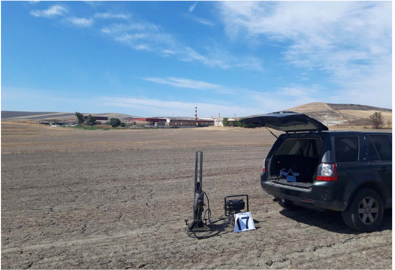
Postazione Prova Penetrometrica Dinamica P17
