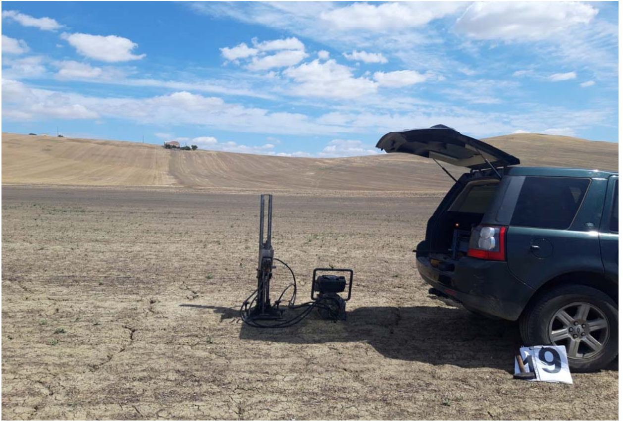
Postazione Prova Penetrometrica Dinamica P19
