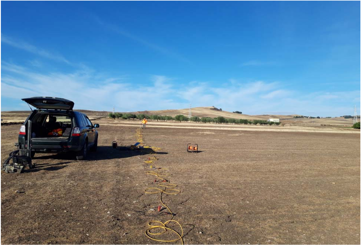
Postazione Rilievo Sismico Tecnica MASW – Masw3
