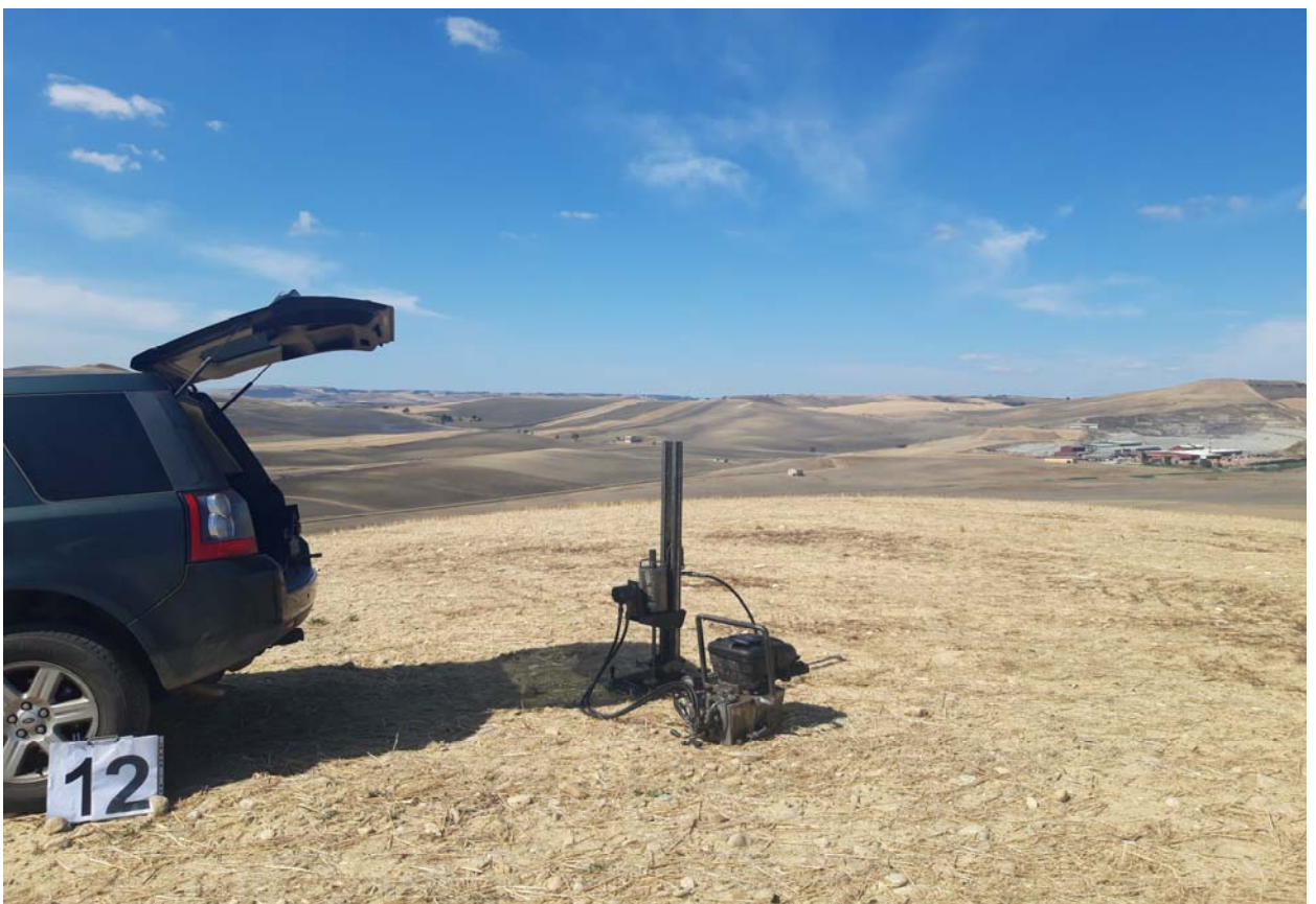
Postazione Prova Penetrometrica Dinamica P12
