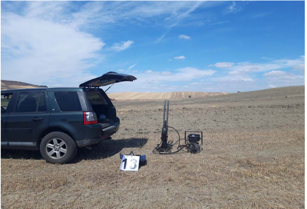
Postazione Prova Penetrometrica Dinamica P13
