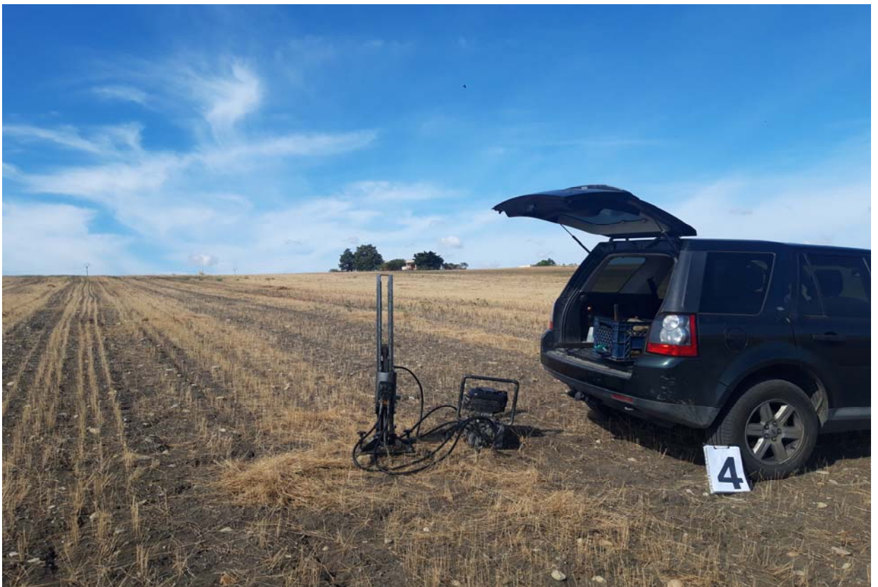
Postazione Prova Penetrometrica Dinamica P4
