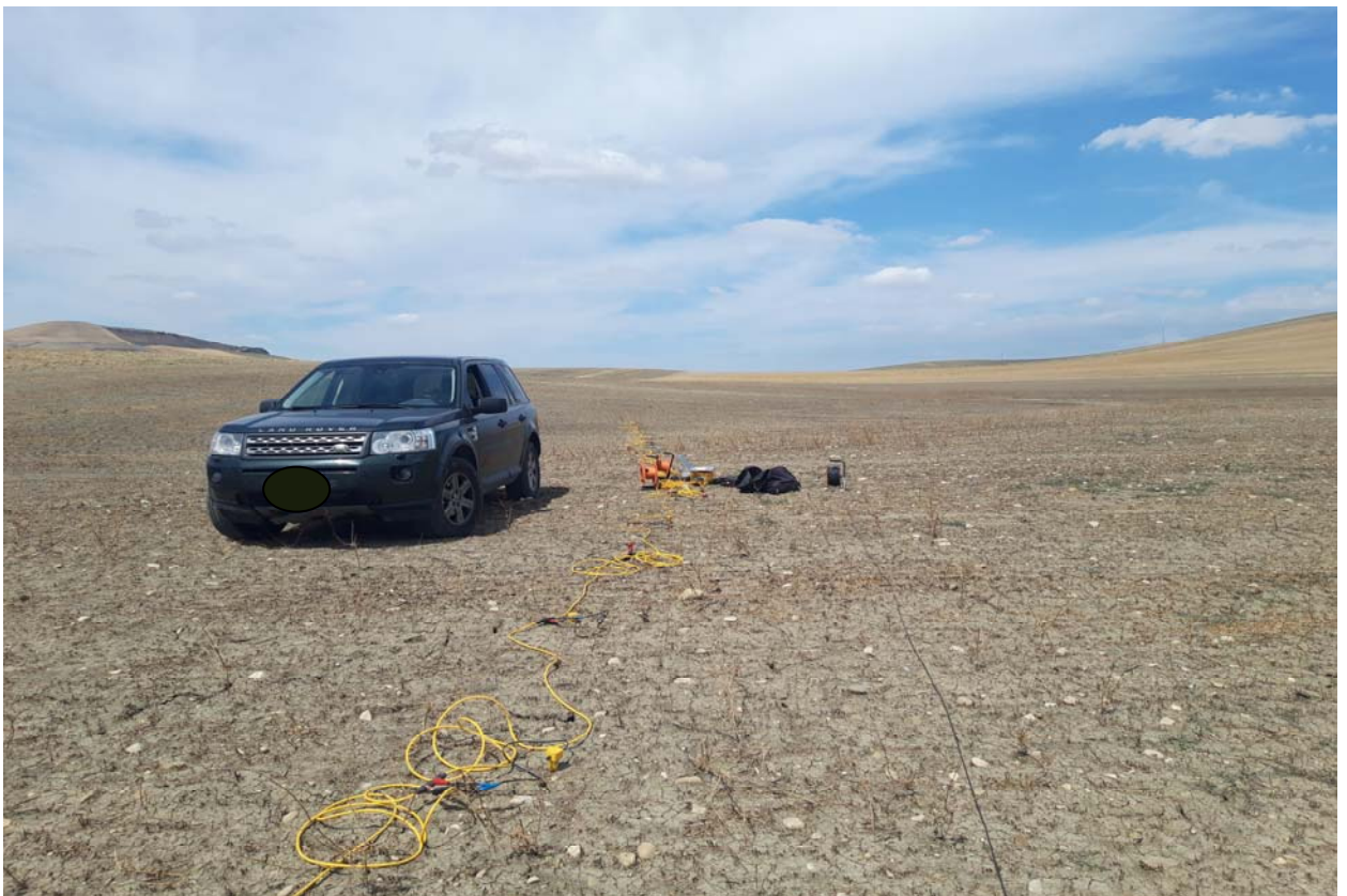
Postazione Rilievo Sismico Tecnica MASW – Masw2
