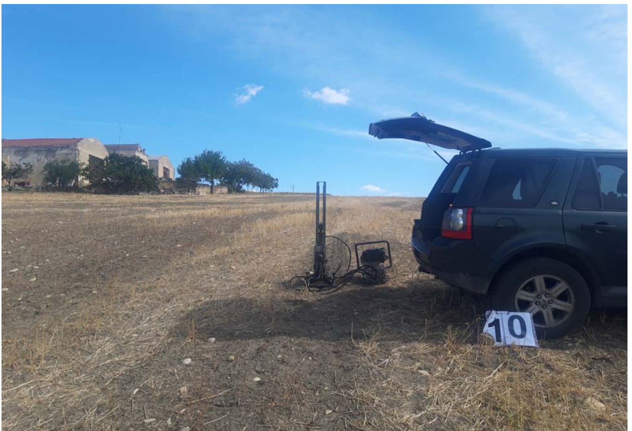
Postazione Prova Penetrometrica Dinamica P10
