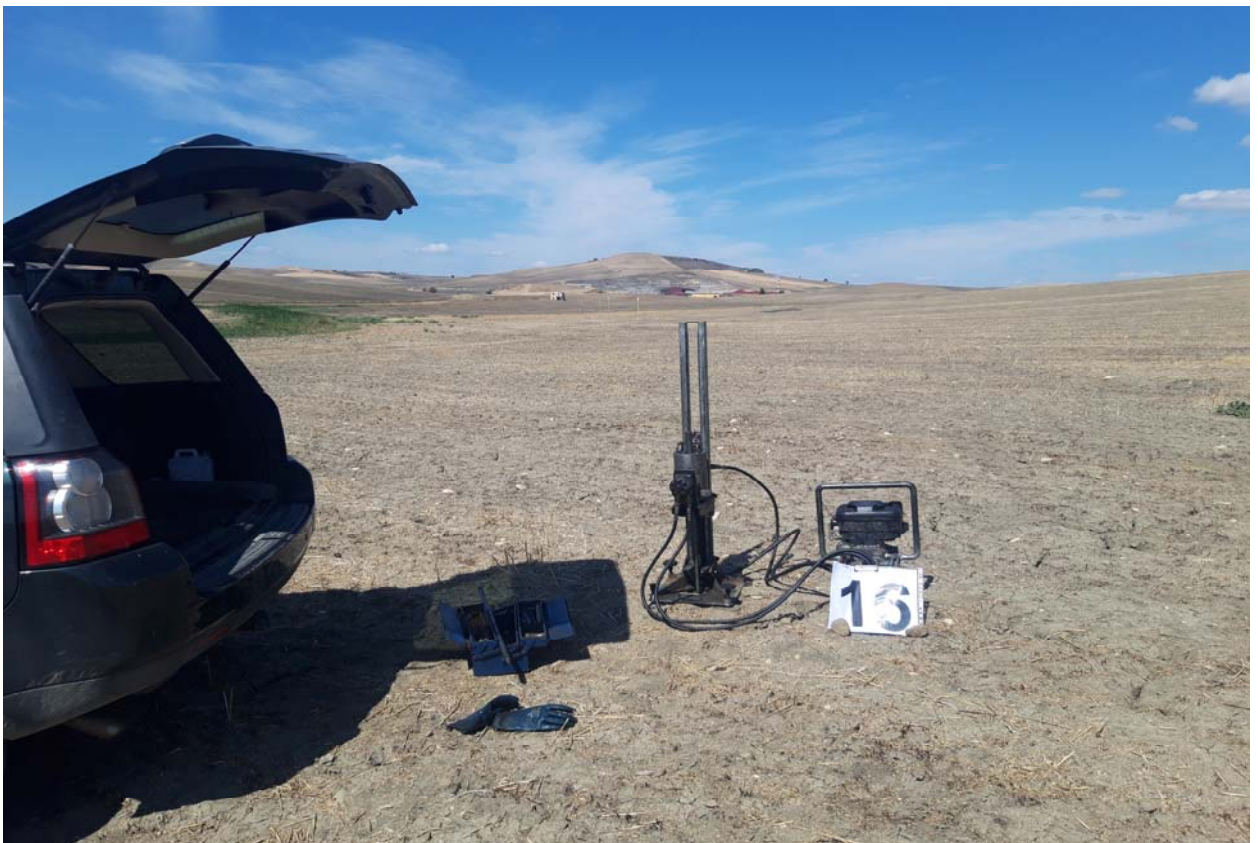
Postazione Prova Penetrometrica Dinamica P16
