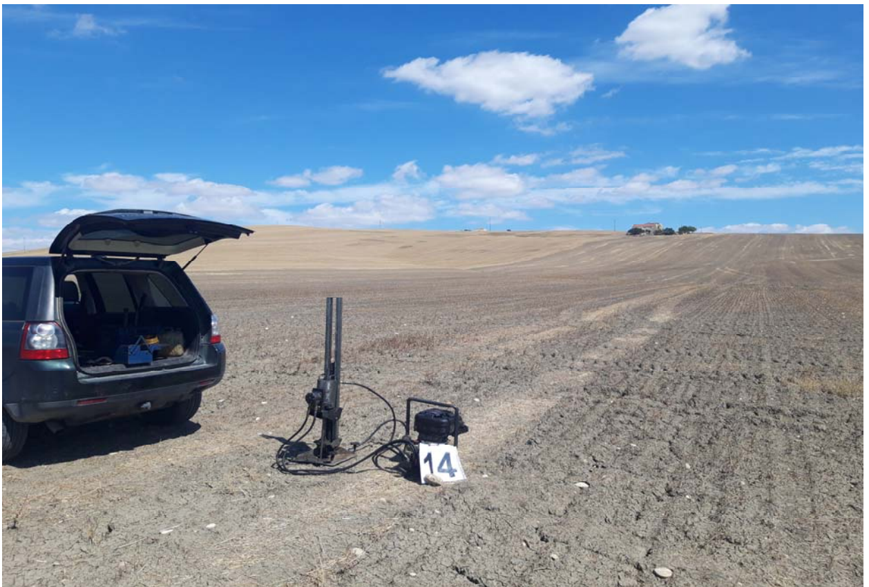
Postazione Prova Penetrometrica Dinamica P14
