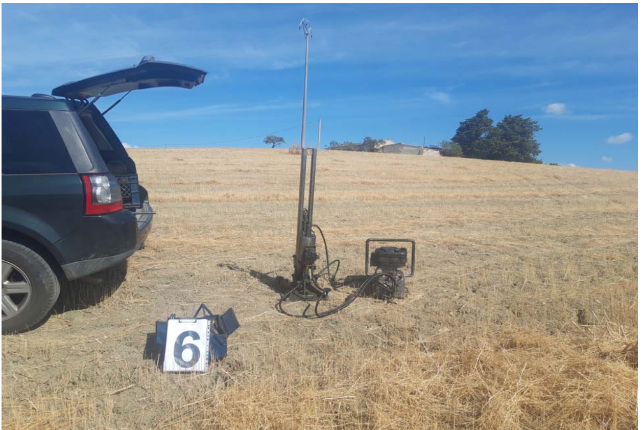
Postazione Prova Penetrometrica Dinamica P6
