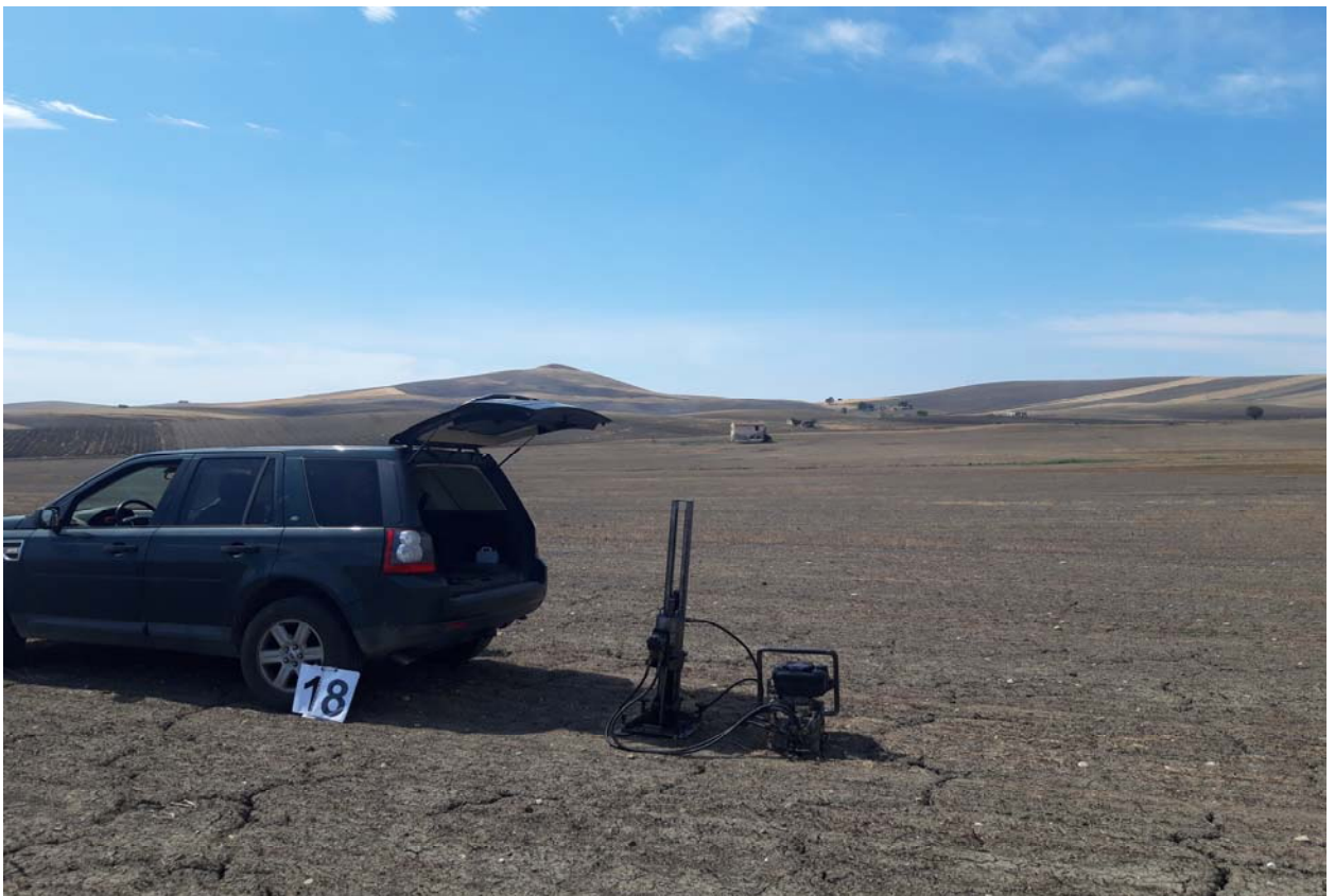
Postazione Prova Penetrometrica Dinamica P18
