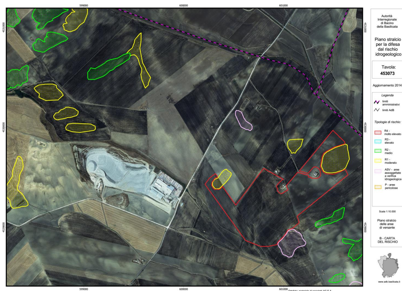
Figura 4 – Mappatura del Rischio Frana rispetto all'area di impianto. Fonte AdB Basilicata.
