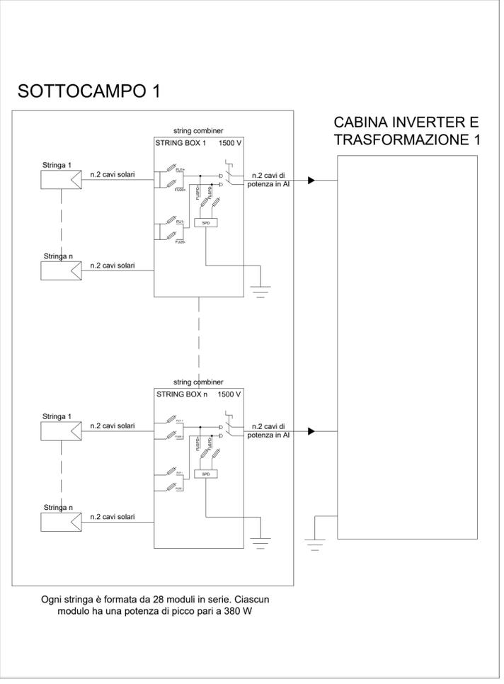
**CAMPO FV AREA 1 - DETTAGLIO CABINA DI CONVERSIONE E TRASFORMAZIONE 12 e 13**
