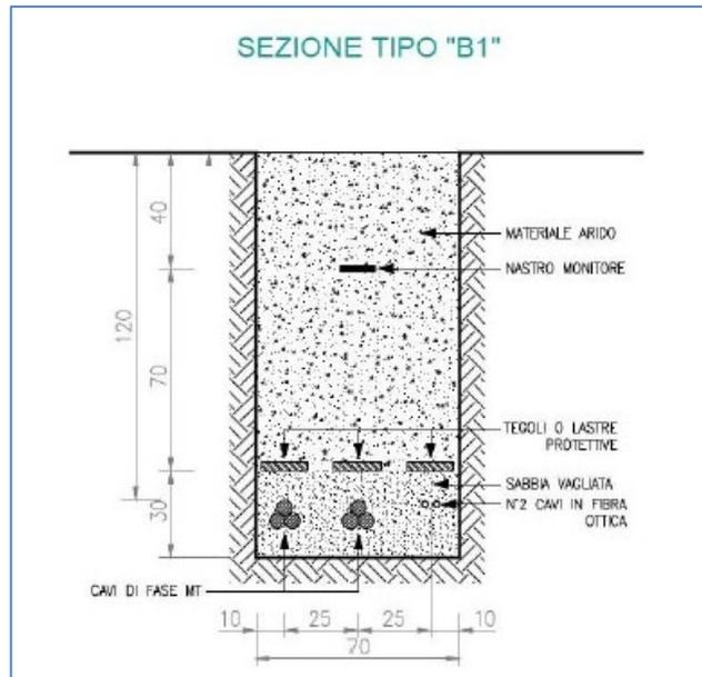
Figura 14 – Sezione tipica di posa della linea di cavo su strade sterrate
