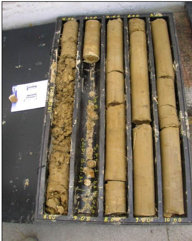
Figura 4: sondaggio n.1 - cassetta da m 5.0 a m 10.0.
