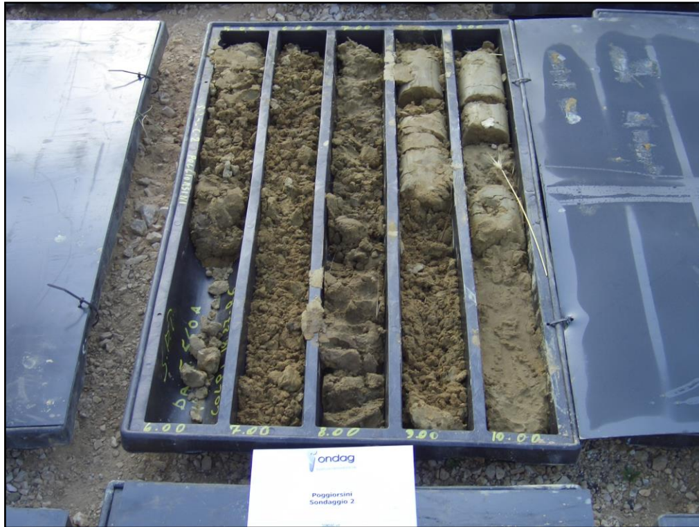
Figura 7: sondaggio n.2 - cassetta da m 5.0 a m 10.0.
