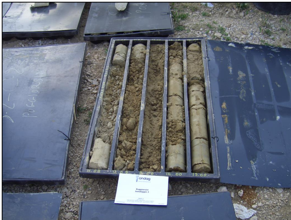
Figura 8: sondaggio n.2 - cassetta da m 10.0 a m 15.0.
