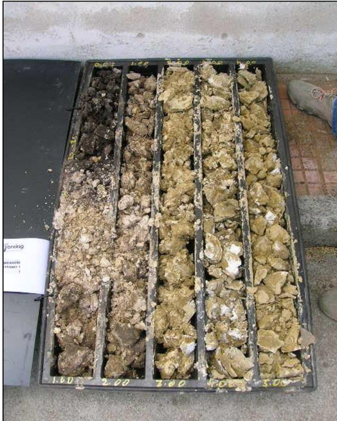
Figura 3: sondaggio n.1 - cassetta da m 0.0 a m 5.0
