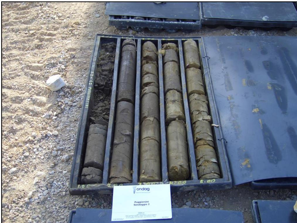
Figura 6: sondaggio n.2 - cassetta da m 0.0 a m 5.0.
