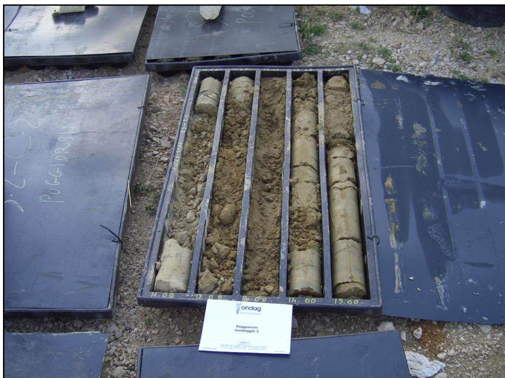
Figura 8: sondaggio n.2 - cassetta da m 10.0 a m 15.0.
