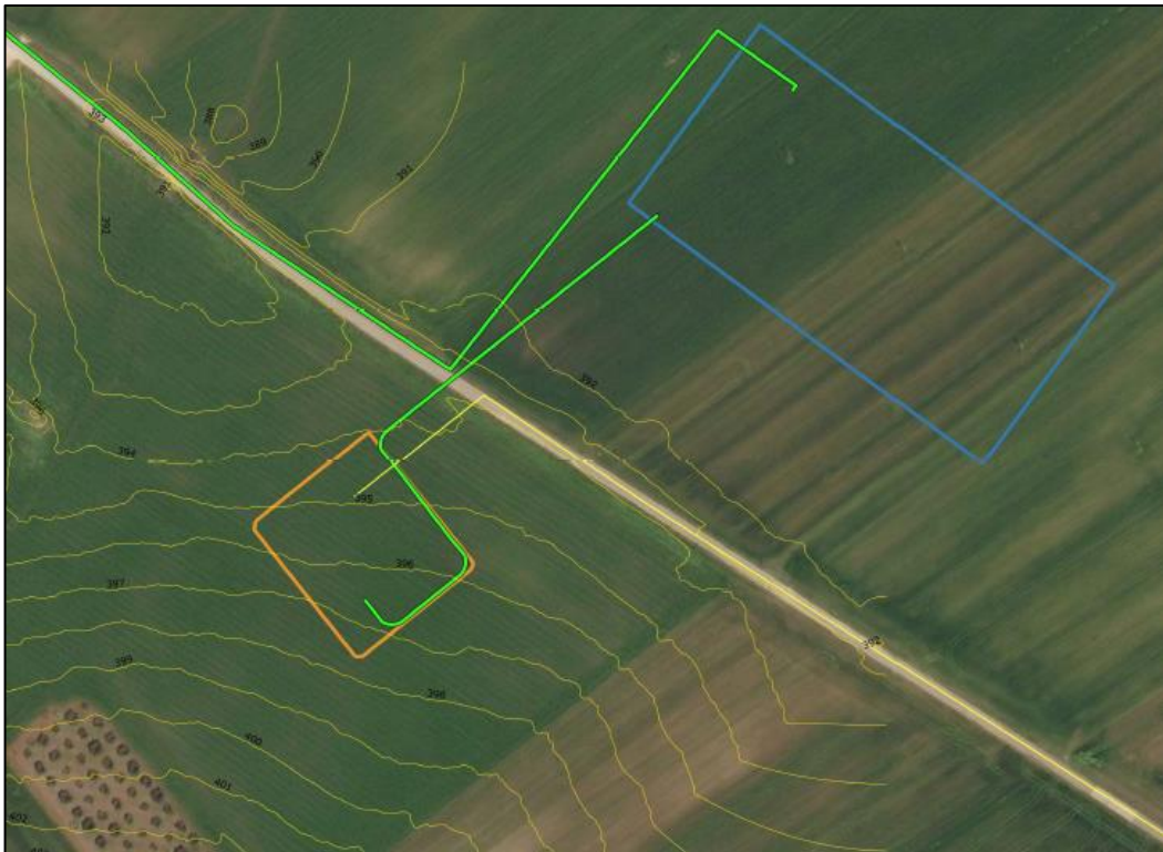
Figura: Curve di livello ad 1 m dell'area della particella catastale del foglio 17 p.lla 21 del Comune di Genzano di Lucania, sede dell'ubicazione della nuova stazione di elevazione.
