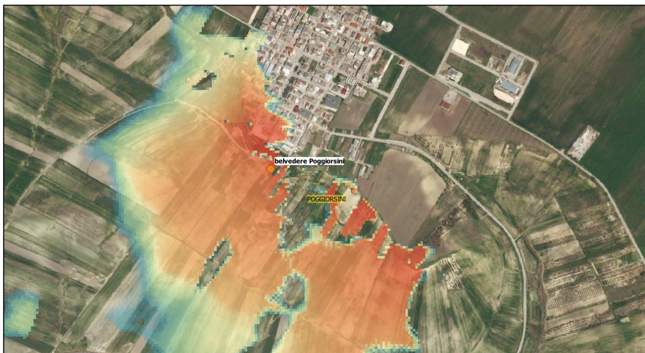
Fig.: Punto panoramico BELVEDERE di Poggiorsini e visibilita con UDS e quinta mitigatoria
