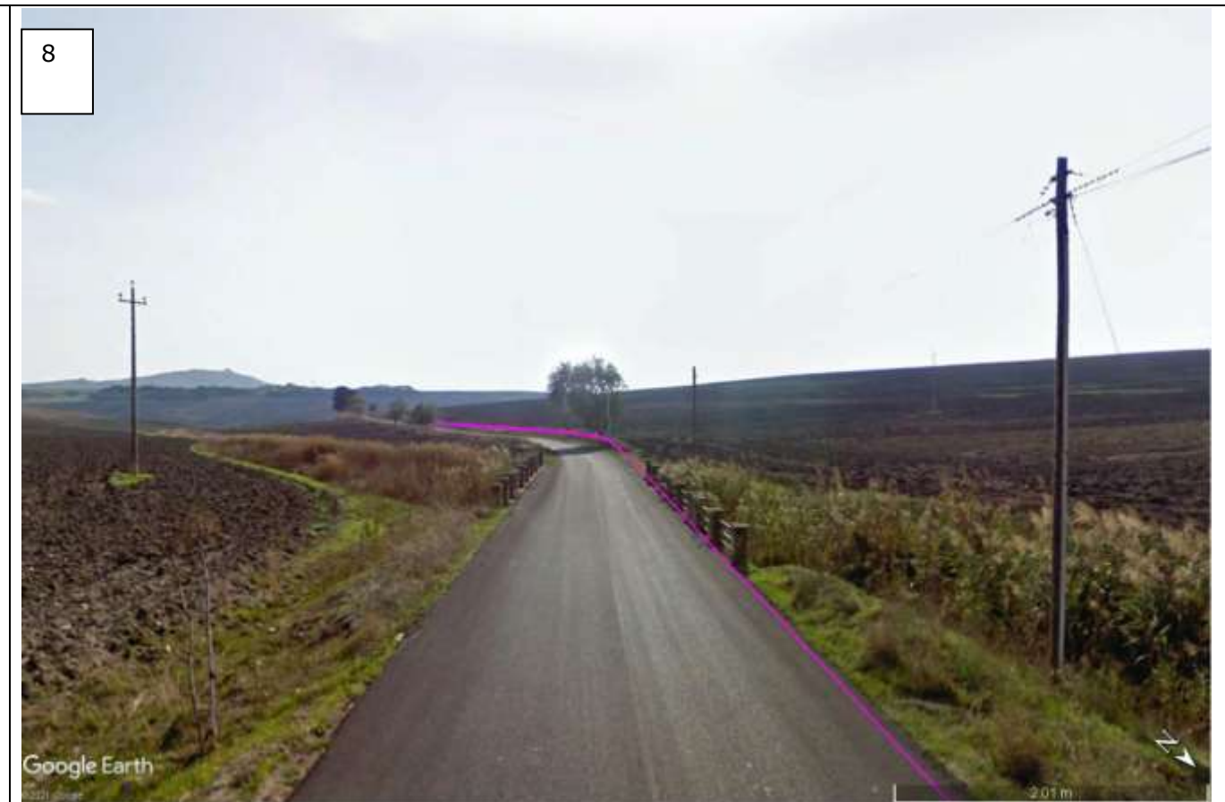
Punto di presa "8" : Vista del tracciato del cavidotto MT sulla SP129 ad incrocio con strada interpodereale e reticolo idrografico
