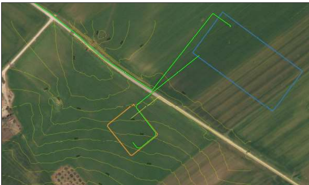
Curve di livello ad 1 m dell'area della particella catastale del foglio 17 p.lla 21 del Comune di Genzano di Lucania, sede dell'ubicazione della nuova stazione di elevazione 30/150 kV.
