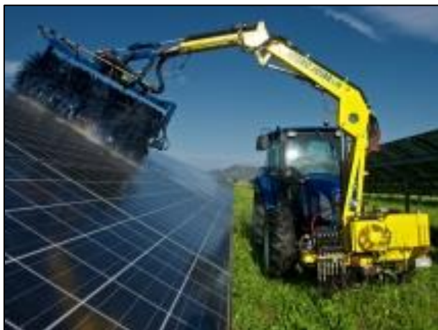
Fig.: Tipico macchina per pulizia moduli FV
