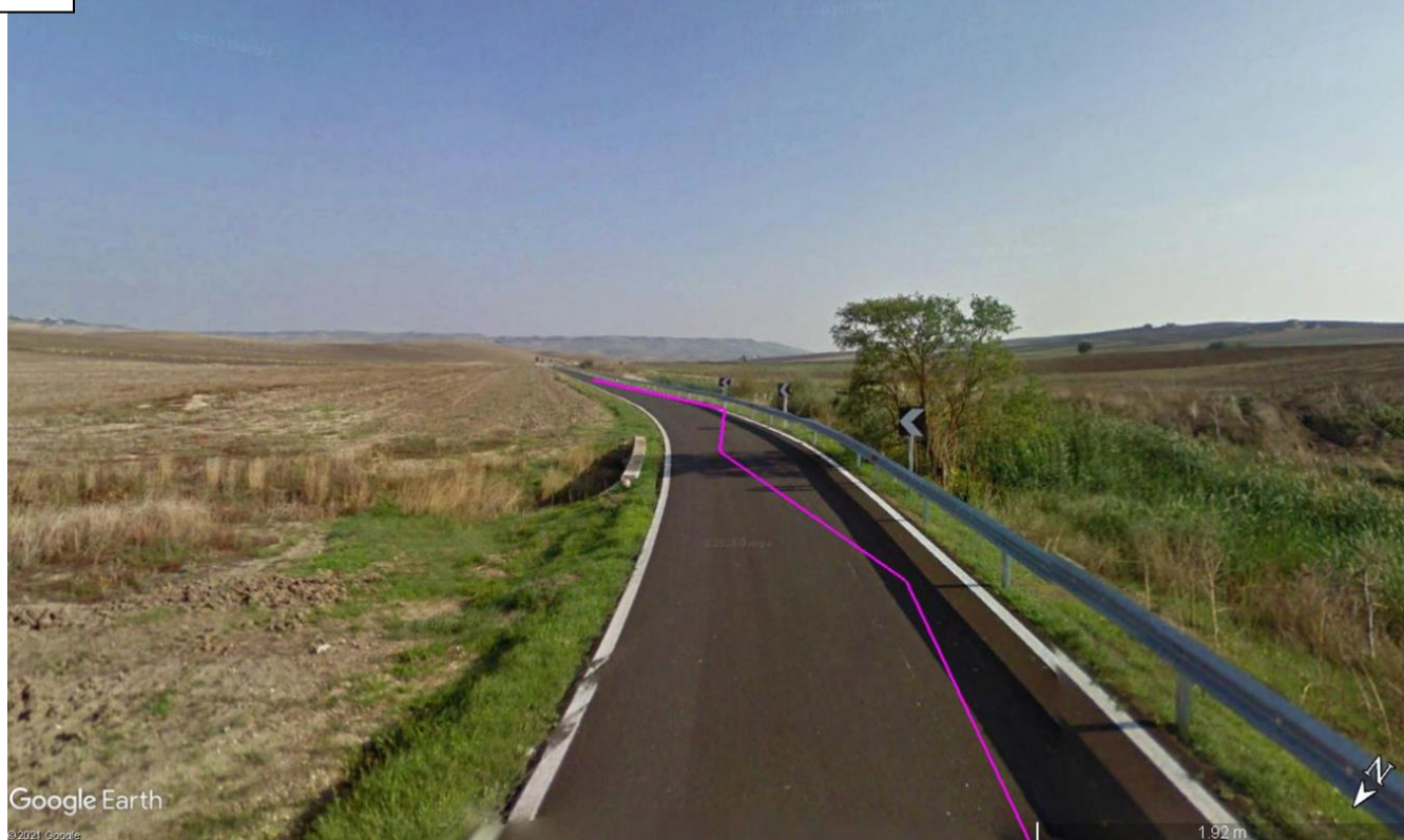
Punto di presa "3" - SP7 - incontro di un tombino: Vista del tracciato del cavidotto esterno MT
