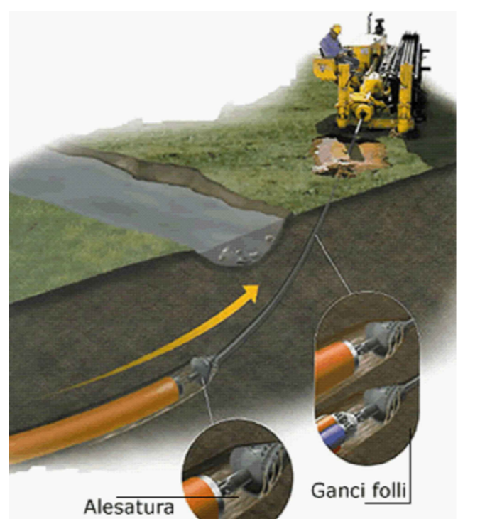
Ritorno: allargamento perforazione e introduzione corrugato per cavidotto
