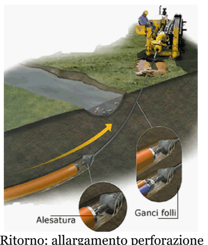
Ritorno: allargamento perforazione e introduzione corrugato per cavidotto
