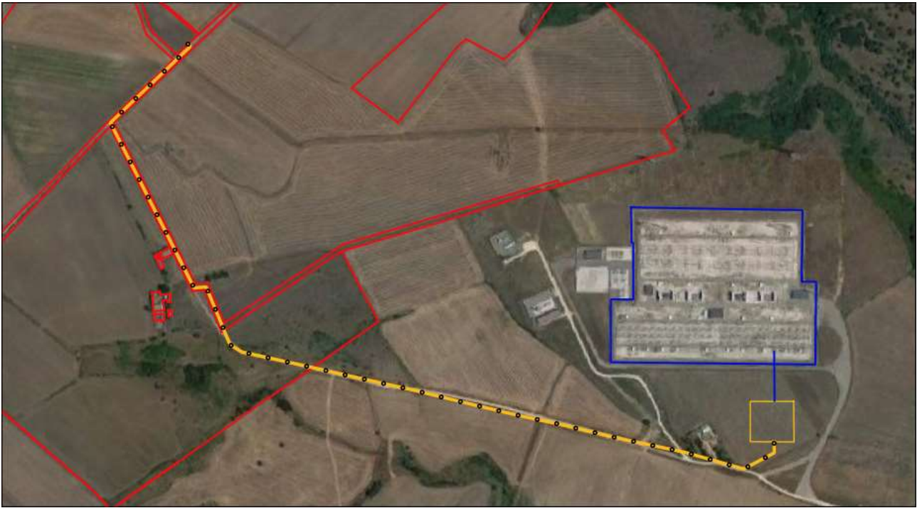
Tracciato interrato della infrastruttura di connessione su immagine satellitare in scala 1:5.000 in giallo il tracciato della connessione interrata e la Stazione Di Elevazione - in blu la connessione aerea
