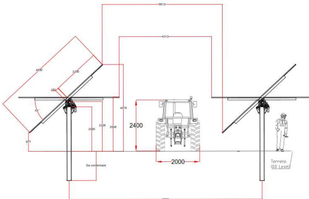
I moduli fotovoltaici saranno installati sull'inseguitore su due file affiancate (orizzontali rispetto all'asse di rotazione del tracker).
