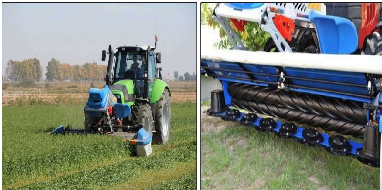
Esempio di falciacondizionatrice frontale e particolare dei rulli in gomma (Foto: BCS)
